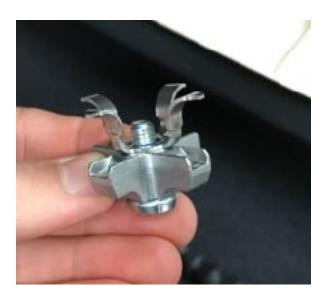
Sind die Metallteile nach unten abgezogen, kann die Antenne mit etwas Kraft und Geruckel oben am Dach abgenommen werden. Dann die Stelle am Dach gut reinigen und trocknen, schließlich die neue Antenne Aufsetzen (vorher die 3 Metallteile von der neuen Antenne abmontieren).
