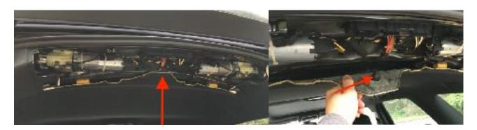
Nun kann man die Dachantenne von unten bereits sehen und die Befestigungsschraube (Torx) lösen. Dazu am besten eine kleine Ratsche / Drehmomentschlüssel verwenden, da der Dachhimmel maximal eine Faust breit nach unten gebogen werden sollte, um hässliche Brüche oder Wellen zu verhindern.
