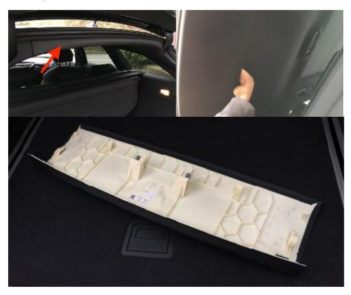
Anschließend noch den vertikalen Clip in der Mitte vom hinteren Ende des Dachimmels nach unten wegziehen, sodass der Dachhimmel in der Mitte nach unten gebogen werden kann.
