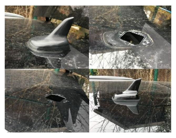
Anschließend die beiden Kreuze von unten wieder mit der Schraube befestigen, die Kabel anstecken und die Dachhimmelblende wieder aufclipsen. Dann noch die Antenne von von oben festdrücken und darauf achten, dass der Gummi rundherum dicht ist.
