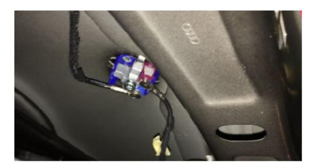
Zum Lösen der Kabel die kleinen weißen Plastikstücke an den Seiten mit einem Schlitzschraubenzieher nach unten schieben, dann lassen sich die farbigen Blöcke an den Steckern abziehen. Funktioniert das nicht, kann das Kabel mit etwas Kraft und Gefühl auch aus dem Block herausgezogen werden - Hier rechts sichtbar bei blau, während bei rot der Block korrekt abgezogen wurde. **Nicht vergessen zu markieren, welches Kabel wo gesteckt ist!**
