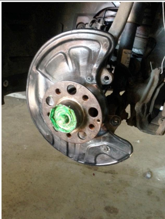
Nabe auf Achsstumpf aufschieben, äußeres Wälzlager einsetzen, Klemmmutter aufschrauben, Klemmschraube einschrauben.
