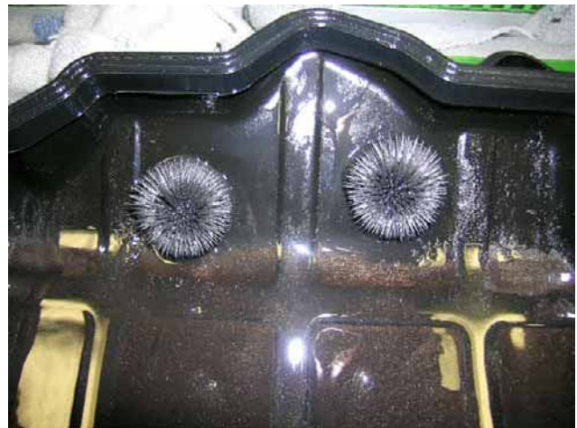
Bild 1: Ölwanne mit erheblichem Spanbild
