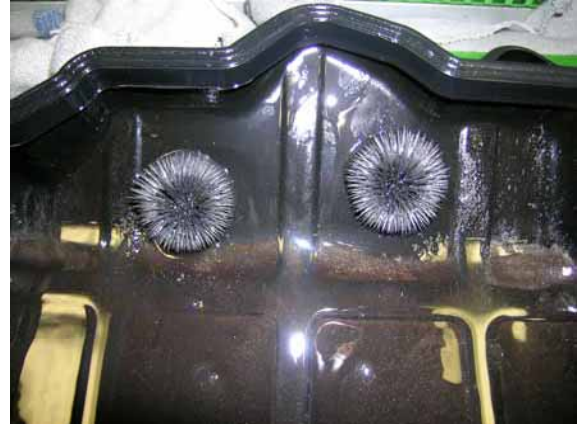
Getriebe mit offensichtlich mechanischen Schäden
