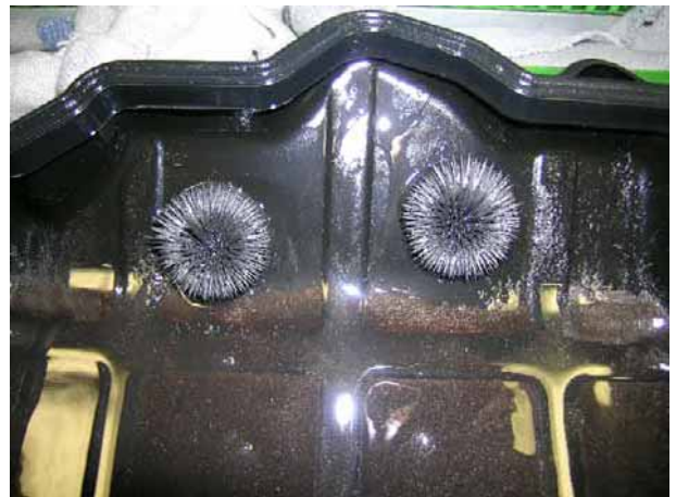
Bild 1: Ölwanne mit erheblichem Spanbild
