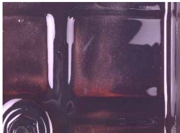
Bild 2: Ölwanne mit „normalem“ Abrieb
