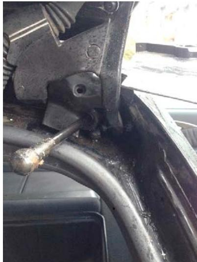
Dazu das Ende des Gasdruckdämpfers nach links (analog auf der linken Fahrzeugseite nach rechts) an der Aufhängung vorbeischieben (die Rückwandtür ggf. weiter max. mit Hand öffnen) und dann dem Dämpfer herausziehen.
