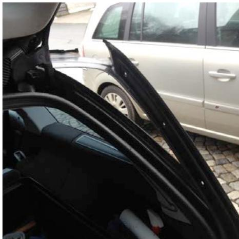
Ein kompletter Ausbau ist nicht notwendig. Es reicht die oberen 4 Spreiznieten möglichst zerstörungsfrei zu entfernen. Unter der Seitenverkleidung sammelt sich im Laufe der Zeit relativ viel Schmutz (verrottetes Laub), was man in dem Zuge entfernen sollte.
