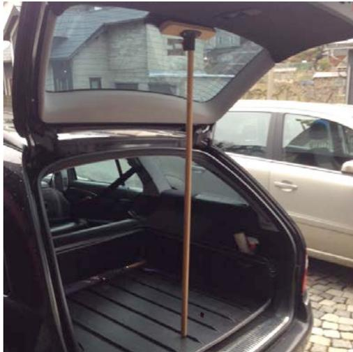
Die Tür ist relativ schwer und fällt bei Entfernung eines Stoßdämpfers herunter, Verletzungsgefahr. Sichern mit Besenstil o. ä.
