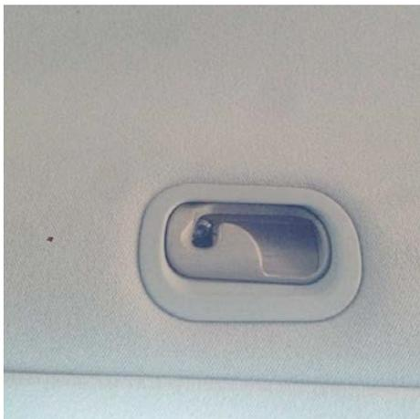
Die Hundennetaufhängung ist mit einer Torxschraube befestigt, die später beim Einbau handfest (8nm) angezogen werden muss.
