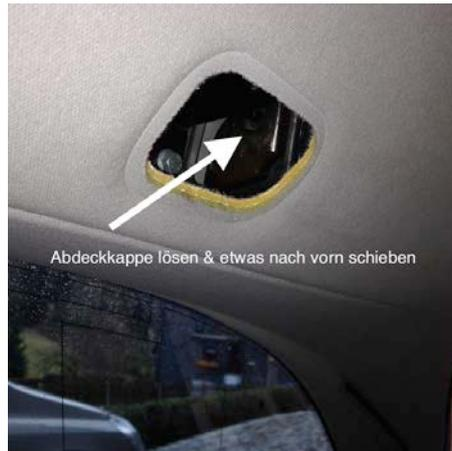
Drückt man die Abdeckkappe mit einem Schraubendreher nun nach vorn erkennt man durch den Spalt den nach oben zeigenden Zapfen, auf dem der Stoßdämpfer eingehangen (geclipst) ist. Eine Taschenlampe/Arbeitslampe ist dabei hilfreich.
