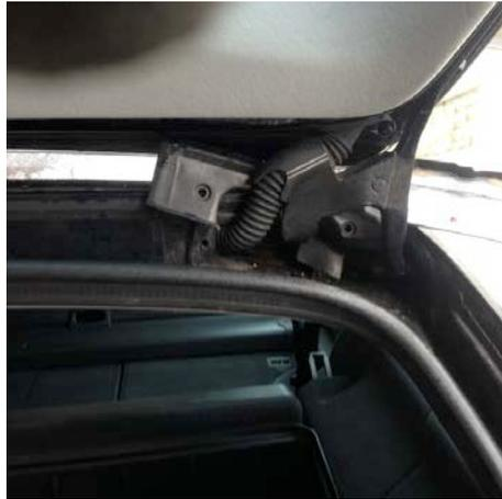
Die Spreiznieten für diese Abdeckung haben in der Mitte einen Stift, der ist nach innen zu schieben bis er abfällt. Dann kann die Niete herausgezogen und die Abdeckung nach oben geschoben werden. Die Stifte sofort sichern, werden für den Einbau gerbaucht!
