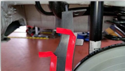
Schraube Torx TX-20 oben innen an Stoßfängerkante herausdrehen. Halter mit Klebestreifen positionieren und mittels Schraube ansetzen. Halter mit Klebestreifen an Stoßfängerkante innen so ausrichten, dass die Abstandshalter anliegen. Rote Streifen abziehen, dabei Lage der Halter nicht verändern und Halter fest an Stoßfänger andrücken.
