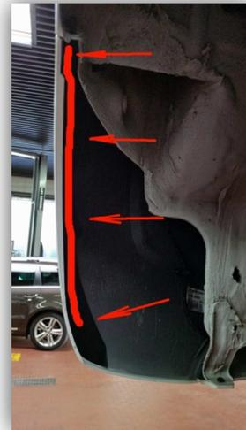
Halter mit Klebestreifen (12E810429 links / 12E810430 rechts) wie gezeigt vorbereiten. Das rote Band muss in montierter Position greifbar sein, ggf. bereits etwas abziehen.
