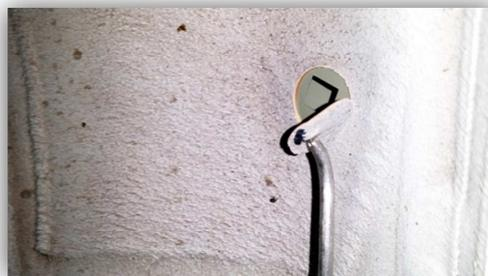
Die 2 Spreizmuttern oben (N 106213 01) in die Löcher oben außen einklipsen, die 3 Spreizmuttern unten (N 908338 01) in die Löcher unten innen einklipsen. Anschließend mit Sprühwachs die Bereiche um die Spreizmuttern konservieren.
