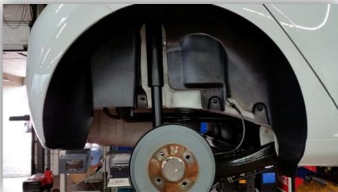
Rad montieren, dazu ggf. die Zentrierung und Anlagefläche reinigen, Radschrauben zunächst mit 60 Nm über Kreuz vorziehen, anschließend bei auf Rädern stehendem Fahrzeug mit 110 Nm über Kreuz festziehen.
