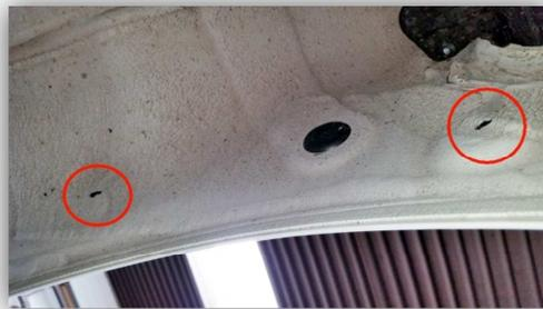
Mittels eines stumpfen Schraubendrehers durch leichten Druck im Bereich der Markierungen die gestanzten Löcher im Karosserieblech suchen. Wenn man genau dort drückt, wo sich unter der Steinschlagschutzschicht ein Loch in der Karosserie befindet, gibt die Schicht nach. An dieser Stelle mit dem Schraubendreher die Schicht, sowie das darunterliegende Tape durchstoßen und mit der Schraubendreherspitze anschließend das Tape vom Blech abhebeln. Diesen Vorgang an allen 5 Markierungen wiederholen.
