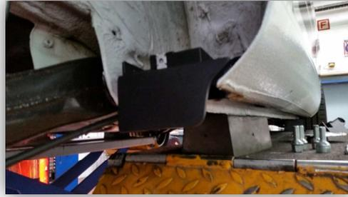
Radhausschale (12E810969A links /12E810970A rechts) vorn am Halter und hinten am Stoßfänger mittels jeweils 1 Schraube N 909747 01 montieren und ausrichten. Jetzt mittels Filzschreiber Stellen der 3 Befestigungspunkte unten innen und 2 Befestigungspunkte oben außen markieren. Radhausschale wieder demontieren.
