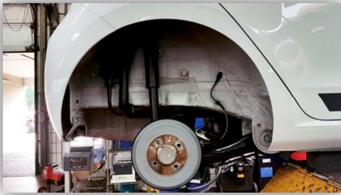
Spreizmutter unten für den Stoßfänger hinten mittels Schraubendreher Torx TX-10 demontieren – diese wird später nicht mehr benötigt. Einsteckmutter 811807577C wie gezeigt im Blechhalter der Karosserie einklipsen, sie hält nur in einer Einbaulage.
