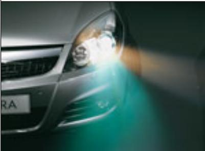
◀ **Das Bi-Xenon-Kurvenlicht (AFL)** besteht außerdem noch aus einer automatischen Leuchtweitenregulierung, einer Scheinwerferreinigungsanlage und dunkel getönten Front- und Heckleuchten.
