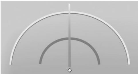
Die Entfernung des Anhängers zur Anhängerkupplung kann mithilfe zweier statischer Kreissegmente abgeschätzt werden.
