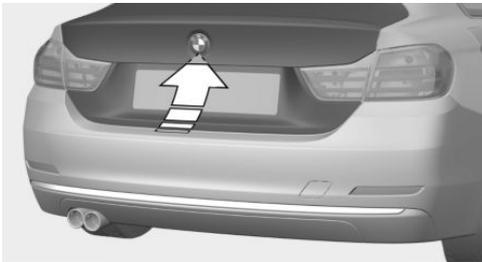
▷ Taste an der Kofferraumklappe drücken.
