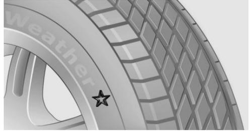
Je Reifengröße werden bestimmte Reifenfabrikate vom Hersteller Ihres Fahrzeugs empfohlen. Diese sind an einem Stern auf der Reifenseitenwand erkennbar.
