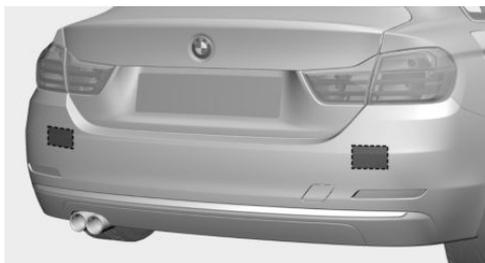
Die Radarsensoren befinden sich im hinteren Stoßfänger.
