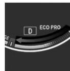
Im Drehzahlmesser zeigt ein langer Pfeil bis zum Nullpunkt der Effizienzanzeige an, dass ein vorausliegender Streckenabschnitt erkannt wurde.
