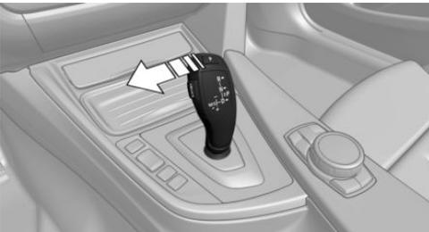
Wählhebel aus Wählhebelposition D nach links drücken.
