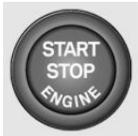
Durch Drücken des Start-/Stopp-Knopfs wird die Zündung ein- oder ausgeschaltet und der Motor gestartet.
