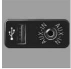
In der Mittelarmlehne kann über den AUX-In-Anschluss oder die USB-Audio-Schnittstelle ein externes Audiogerät, z. B. ein MP3-Spieler, angeschlossen
