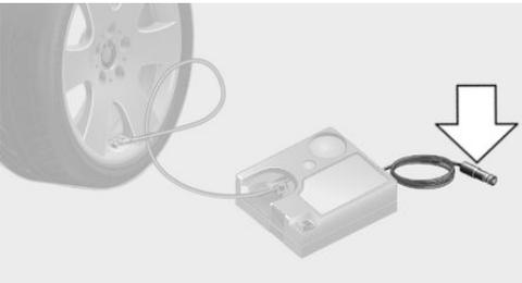
5. Reifenfülldruck auf 2,5 bar korrigieren.
