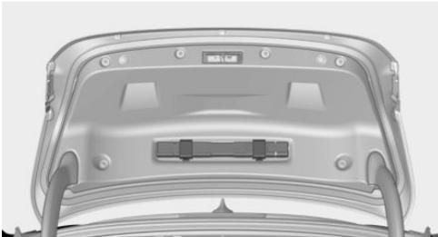
Das Warndreieck befindet sich auf der Innenseite der Kofferraumklappe.
