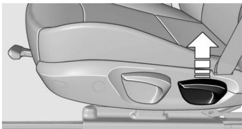
Hebel ziehen und die Lehne nach Bedarf be- oder entlasten.
