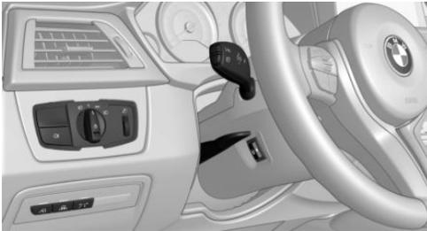
Das Lichtschalterelement befindet sich neben dem Lenkrad.
