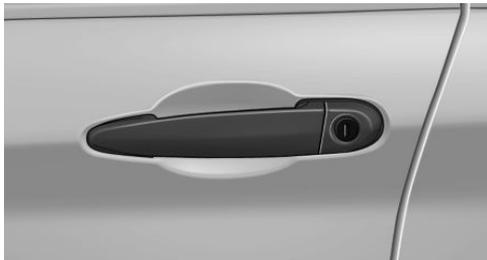
Fahrtür über das Türschloss mit dem integrierten Schlüssel, siehe Seite 32, entriegeln oder verriegeln. Die anderen Türen müssen von innen entriegeln oder verriegelt werden.
