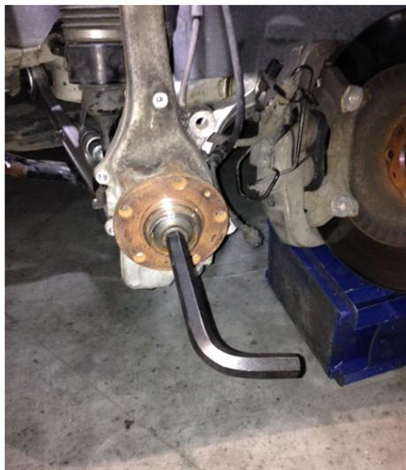
Die Gelenkwelle vorsichtig aus der Nabe schieben und alle 4 M12 Innenvielzahn-schrauben lösen
