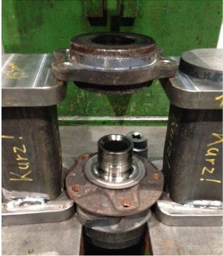
Von der Nabe ist der alte Staubschutzring mit einem Schraubendreher zu entfernen.
