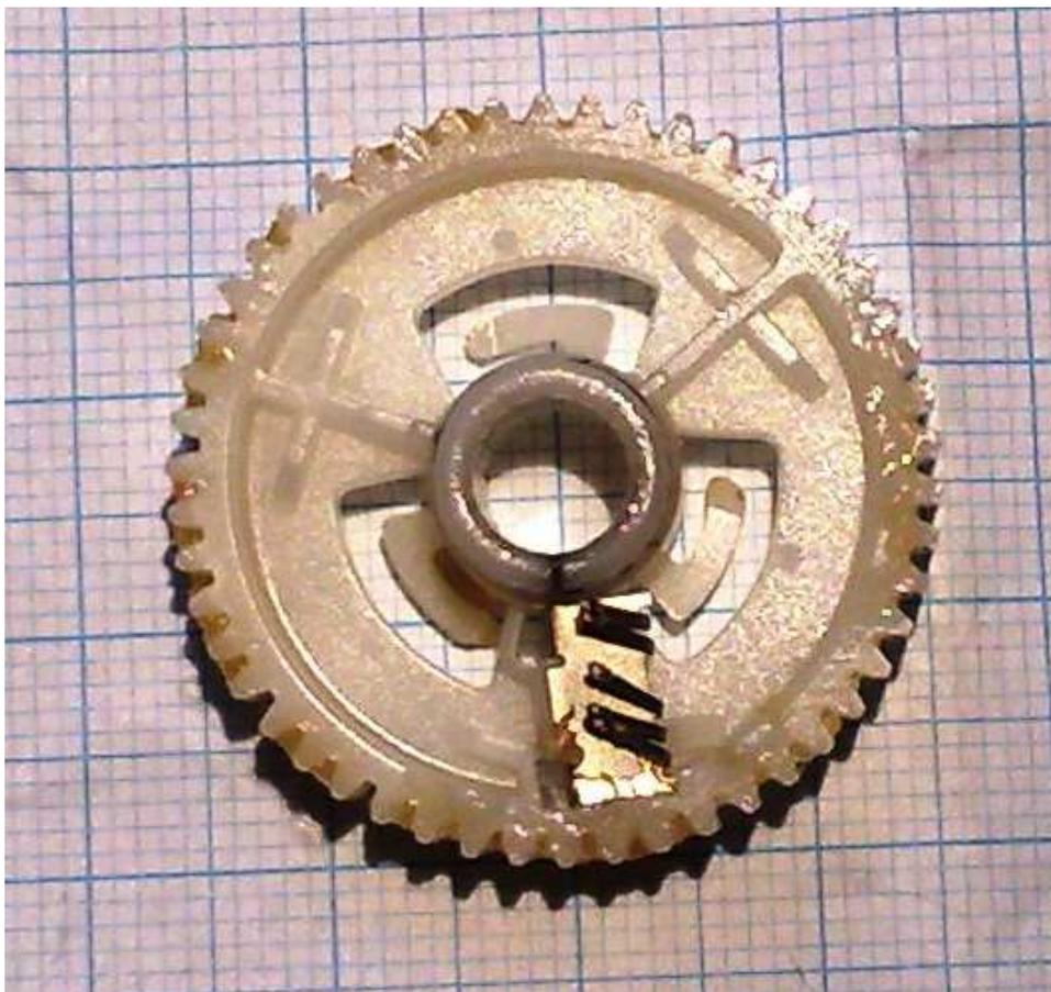
Bild 3: Das abgezogene Zahnrad von unten mit den aufgesteckten Schleifkontakten aus Metall. Man erkennt eine weitere Fehlerquelle: verbogene oder abgebrochene Kontaktfinger, bzw. Schmutz- oder Fettfilm.
