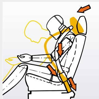
Bei einer Kollision werden die 3-Punkt-Sicherheitsgurte von Fahrer und Beifahrer durch den Gurtstraffer blitzschnell fest an den Körper angelegt.
