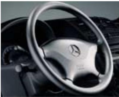
In Höhe und Neigung verstellbares Lenkrad
