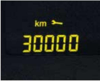
Wartungsrechner ASSYST für einsatzabhängige, flexible Ölwechselintervalle
