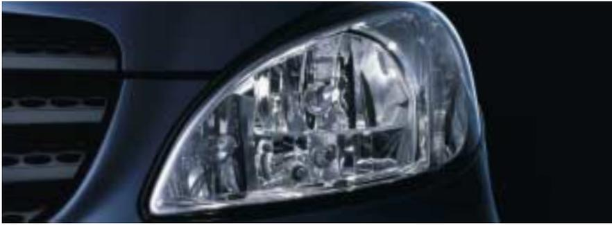
Scheinwerfer in Klarglastechnik mit Leuchtweitenregulierung,
