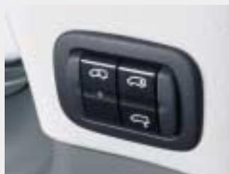
*Maximum an Komfort und ausgeglichenes Fahrverhalten in allen Beladungssituationen: Mit der optionalen Luftfederung lässt sich die Hinterachse auf Knopfdruck um bis zu 50 mm anheben bzw. absenken.*
