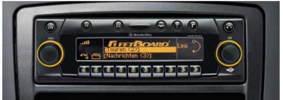
*Das Kommunikationssystem »Sound 40 Pro« kombiniert zahlreiche Kommunikationsleistungen: Es macht als Telematikplattform das Dienstpaket FleetBoard Disposition nutzbar und ist mit Telefon, Freisprecheinrichtung, Navigationssystem, Radio, CD-Player und WAP-Browser ausgestattet*
