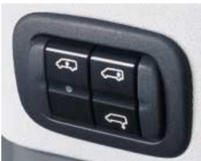
Luftfederung an der Hinterachse
