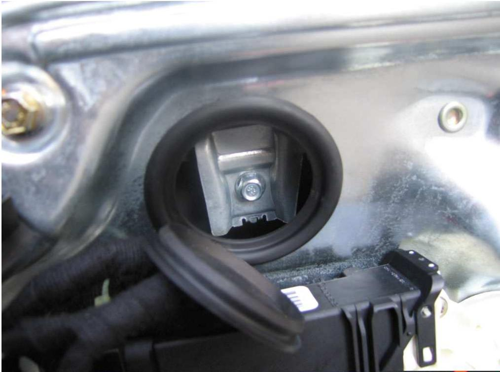
Mit einer 10er Nuss diese Schrauben lösen und die Scheibe VORSICHTIG nach oben ziehen, um sie dann mit „Panzertape“ festzukleben.
