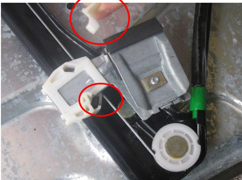
Jeder vernünftig denkende Mensch sieht auf den ersten Blick dass so was eigentlich gar nicht funktionieren KANN. Plastik wird auf Dauer spröde und bricht. Der Rest ist bekannt. Zum Glück blieb mir der Schock der bei Regen in die Tür fallenden Scheibe erspart...
