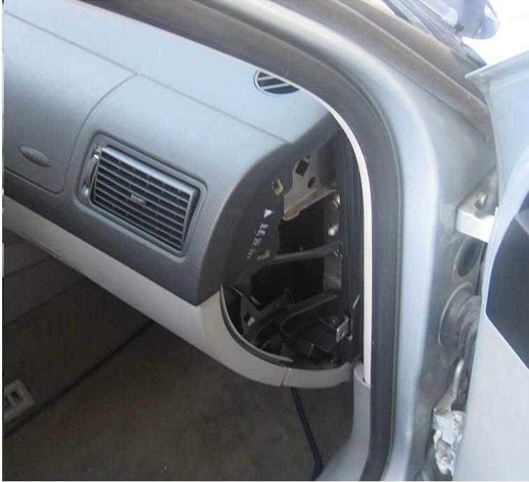
Das Handschuhfach ist mit insgesamt 7 Torx Schrauben befestigt. 6 davon sind frei zugänglich (3 nur bei geöffnetem Handschuhfach sichtbar, 3 im Fußraumbereich unten), für die siebte muss man jedoch die Mittelkonsole lösen und etwas nach hinten schieben (ganz ausbauen ist nicht notwendig!). Dies geschieht durch Lösen einer Schraube am Fußende jeder Seite und durch zwei, durch einen Plastikclip versteckte, rechts und links von den Gurthaltern der Sitze.
