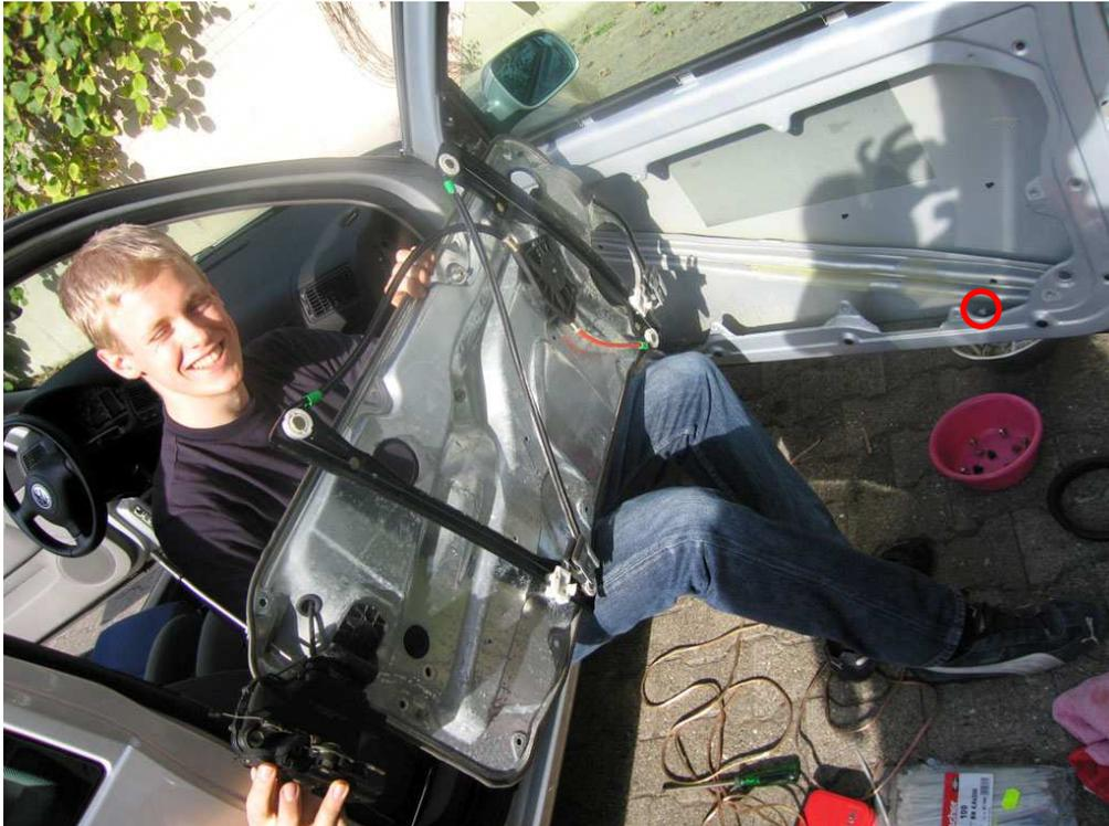
Das Türschloss etwas abstützen, damit die Halterung nicht zu sehr belastet wird. Sollte die eine Niete an der Halterung gebrochen sein, nicht verzweifeln, das ist normal und nicht weiter schlimm. Kann ohne weiteres auch so wieder eingebaut werden, halten tut die sowieso so gut wie nichts.
