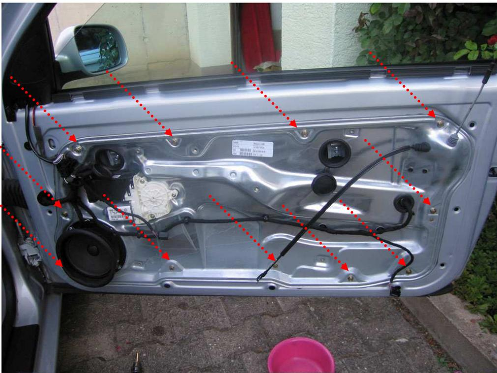
Der Träger sitzt mitunter sehr fest. Er muss evtl. mit etwas Kraft abgezogen werden. Beim Zusammenbau beachten: Diese Schrauben werden mit 10Nm wieder angezogen!
