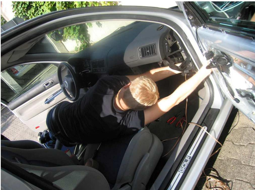
Nun liegen also in die rechte Tür insgesamt 2 neue Lautsprecherkabel mit jeweils 2 Adern, deren anderes Ende irgendwo an der Mittelkonsole bzw. unter der Lenkradverkleidung liegt.
