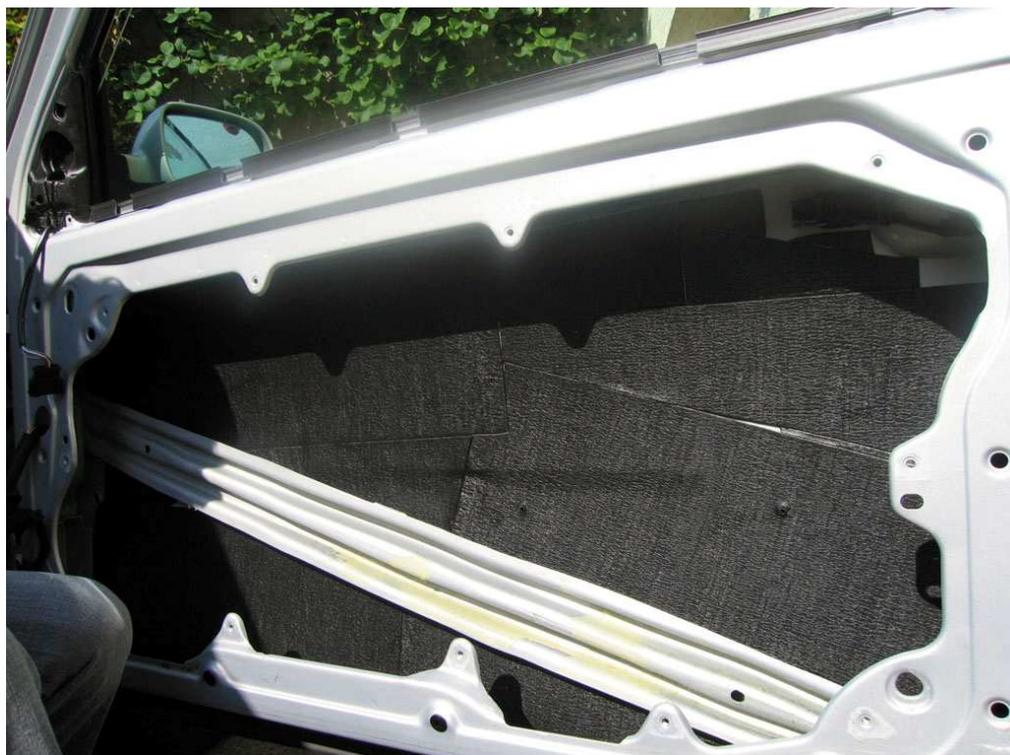
Weiter geht's mit dem Aggregatträger. Dieser wird innen ebenfalls noch gedämmt, die ist aber leider etwas aufwendiger als die Türinnenseiten, denn hier muss man nun aufpassen, dass man keine Löcher überklebt, die für Kabel oder ähnliches gebraucht werden. Daher muss man mehr kleinere Teile zuschneiden und verarbeiten, und das braucht mehr Zeit. Am Ende sieht's dann aber so aus:
