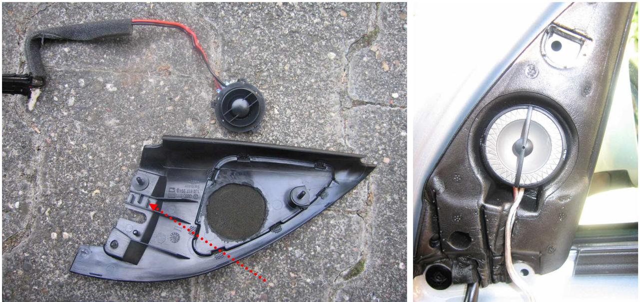
Um das neue Kabel einfacher zu verlegen, kann man die drei Winkelstücke rausbrechen (s. Pfeil). Der neue Hochtöner (rechtes Bild) wird mit Heißkleber im Schaumstoffteil der Tür befestigt und anschließend das Spiegeldreieck aufgesetzt.
