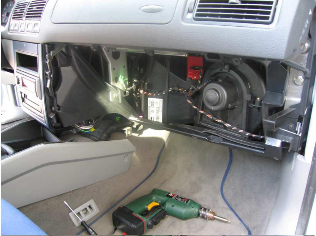
Die neuen LS-Kabel (ein Paar für den Tieftöner, eins für den Hochtöner) werden entweder an bestehenden Kabelsträngen oder an Metallteilen mit Kabelbindern befestigt und am rechten Ende durch das Türgummi gezogen (Fummelarbeit) um letzten Endes wie der originale Kabelstrang durch eine Gummitülle zur Tür verlegt zu werden (noch mehr Fummelarbeit). Gut wenn man da einen geschickten Helfer hat =)
