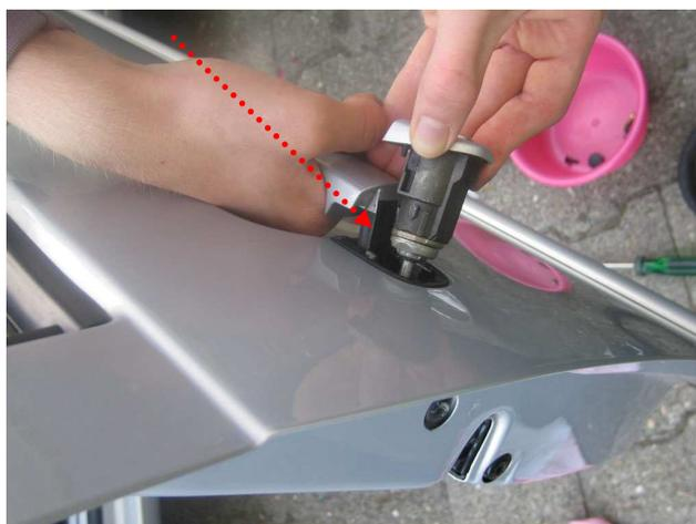
Nun mit der Vielzahn Nuss die 2 schwarzen Schrauben am Schloss lösen. Diese werden nachher beim Wieder Einbau mit 20Nm gleichmäßig angezogen.
