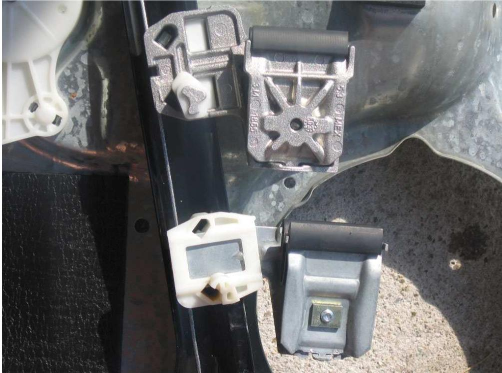
Der Reparatursatz besteht aus der Spannrolle der Seile, 3 runden Dichtungen sowie den zwei Metallhalterungen. Das Querseil in der Mitte wird wieder verwendet. Zur Montage muss der Fensterhebermotor auf der anderen Seite an 3 Kreuzschlitzschrauben entfernt werden. Dann kann die (hier schwarze) alte Spannrolle entfernt werden. Vorher die alten Träger aus den Seilen haken.
