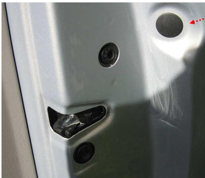
Während die Schraube langsam herausgedreht wird, den Türgriff ziehen und am Schließzylinder ein bisschen wackeln. Wenn die Schraube weit genug gedreht ist, kann der Schließzylinder herausgezogen werden. Ist dies geschehen, die Schraube am Besten wieder 2 Umdrehungen rein schrauben, dann geht sie auf keinen Fall verloren. Den Schließzylinder beiseite legen und den Seilzug am Türgriff vom Schloss herausclipsen (s. Pfeil).
