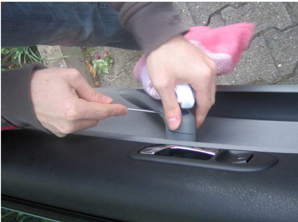
Mit einem flachen Schraubenzieher und etwas Kraft ist der Griff abzubekommen. Vorsicht ist geboten um das Plastik nicht zu beschädigen, evtl. ein Tuch unter den Schraubenzieher legen. Der Griff ist mit 3 Metallklammern gehalten. Aufpassen, dass diese beim Ausbau nicht verloren gehen.
