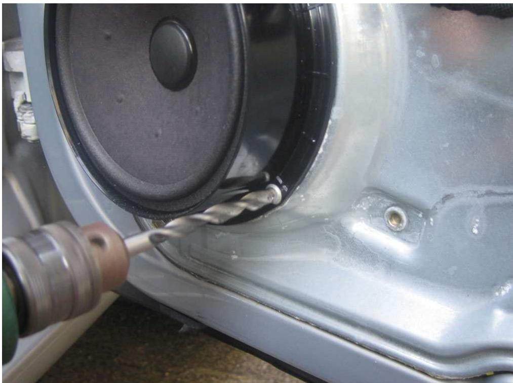
Die überstehenden Reste der Nieten können, je nachdem wie weit sie aufgebohrt wurden, einfach mit einem Hammer durchgeschlagen werden. Geht das nicht, sollte man sie mit einem Dremel entfernen, da sonst durch zu viele Schläge mit dem Hammer nur das Blech des Aggregatträgers verbiegt, sich sonst aber nichts tut. Anschließend alle Nieten- und Metallreste aus der Tür sorgfältig entfernen.
