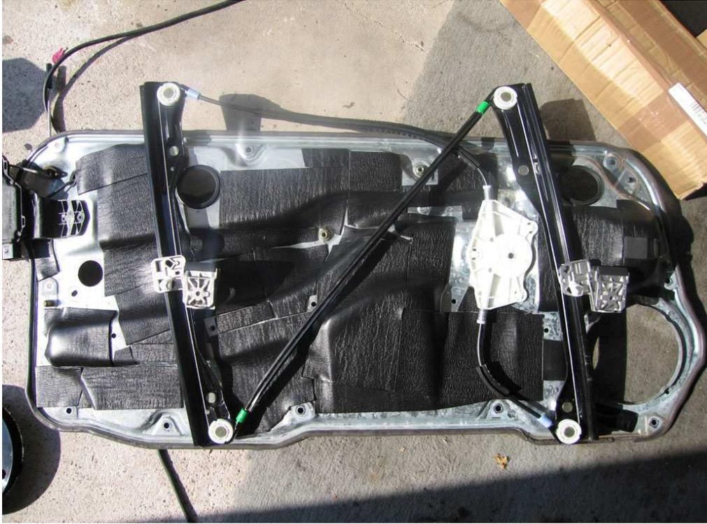
Sinn der Dämmmatten ist das Beschweren der Metallteile. Da träge Masse schwieriger zum Schwingen zu bringen ist, werden Resonanzen vermieden, wodurch der Klang insgesamt sauberer, harmonischer und weniger blechern/scheppernd wird.
