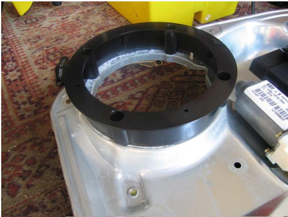
Nun kann der Aggregatträger wieder eingebaut werden. Besondere Vorsicht sollte auf das Schloss gelegt werden, denn dies ist meistens am schwierigsten einzufädeln. Nachdem alle Kabel wieder an der Tür befestigt und angeschlossen sind, können die 11 Schrauben wieder befestigt werden (10Nm). Das Schloss wird mit den Vielzahnsschrauben (20Nm) befestigt, der Seilzug am äußeren Griff eingehängt (Fummelarbeit) sowie der Schließzylinder wieder eingesetzt und durch die Schraube seitlich festgeschraubt.
