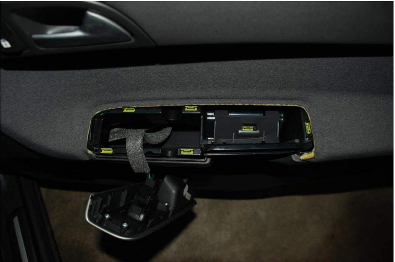
Dann Bedienpanel herausnehmen und Stecker abziehen (Zündung muss laut Volvo mindestens fünf Minuten aus sein bevor der Stecker abgezogen werden darf)
