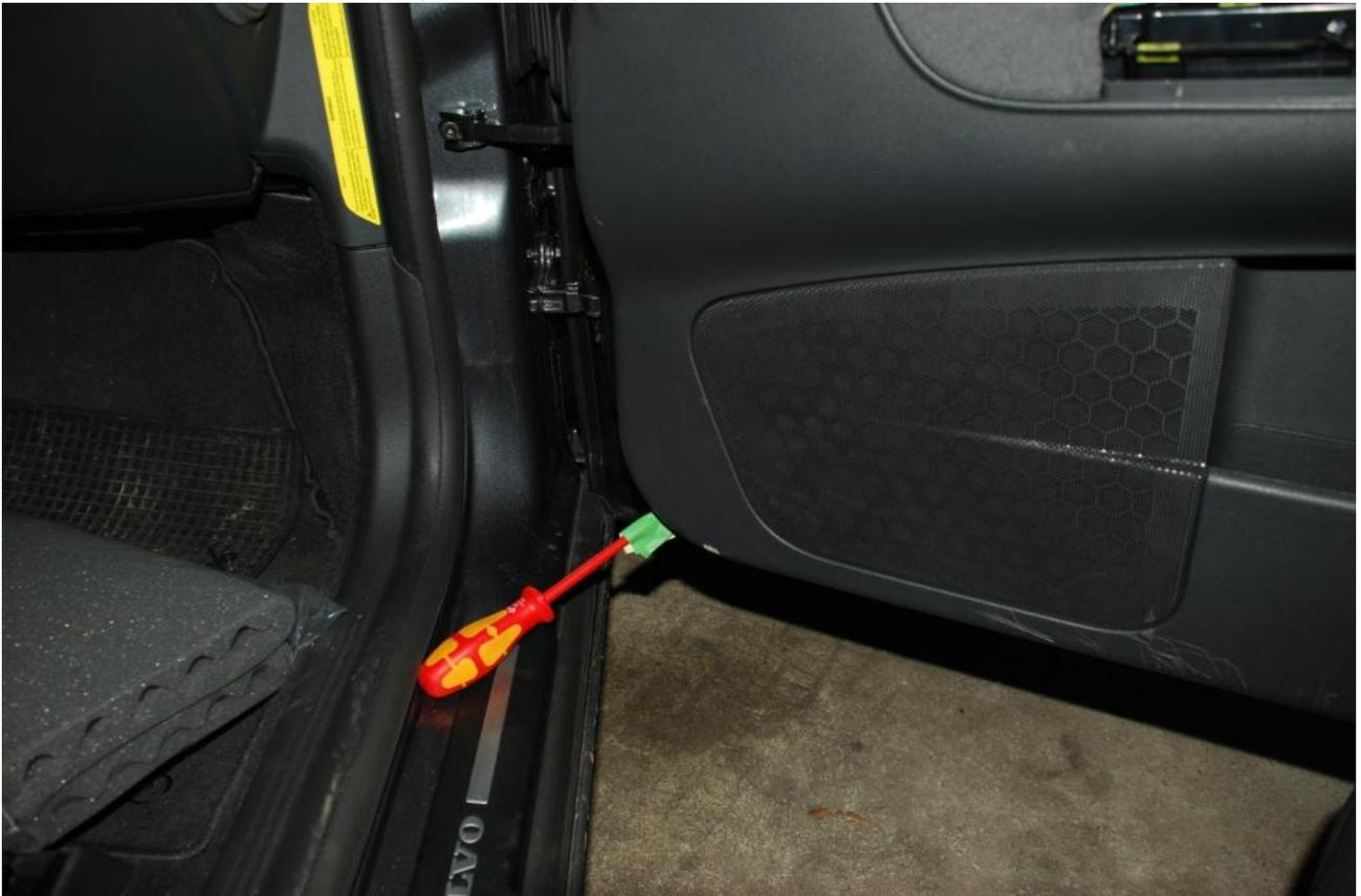
Dann folgt der anstrengendste Teil die Türverkleidung wegheben, zuerst an einer Ecke loshebeln dann ziehen jeder Clip macht einmal laut „knack“ dann sind sie offen. Bei den weiteren Türen habe ich mir spezielles Aushebelwerkzeug geholt spart Zeit, Nerven und Kraft und es geht sicher nichts kaputt.
