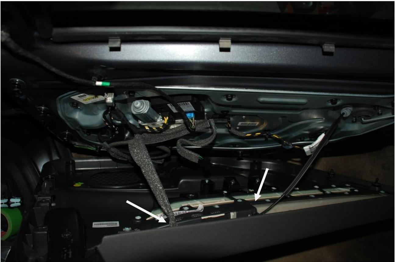
Stecker Türverriegelung und Seilzug vom Türöffner entfernen bzw. aushängen.
