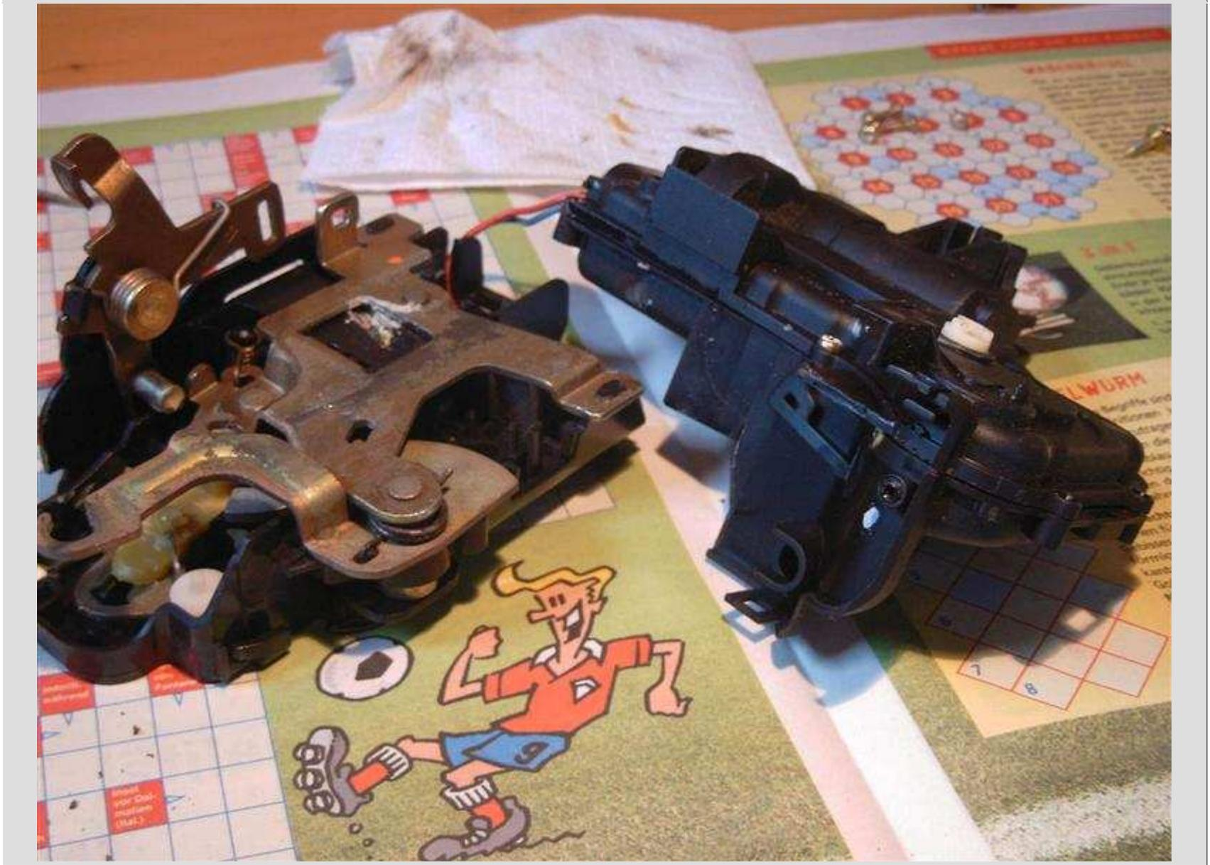
Jetzt sollte das Ganze so aussehen. Sämtliche Reparaturversuche beschränken sich auf die Kunststoffbox mit der Elektrik (Im Bild rechts). ein Mikroschalter befindet sich auch im Schloss (daher die Kabel zwischen den beiden Teilen), dieser ist meines Wissens für die Innenraumbeleuchtung zuständig.
