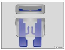
Abb. 011 Darstellung einer durchgebrannten Sicherung
