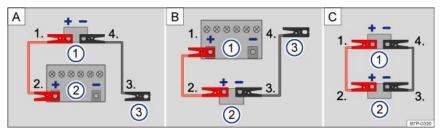
Abb. 014 Das Anklemmen der Starthilfekabel gemäß Variante A, B oder C ist abhängig von der Fahrzeugausstattung.
