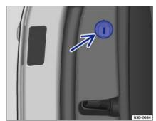
Abb. 002 In der Stirnseite der hinteren linken Tür: Notverriegelung, durch eine Gummidichtung abgedeckt.
