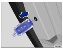
Abb. 003 Notverriegelung des Fahrzeugs mit dem Fahrzeugschlüssel.
