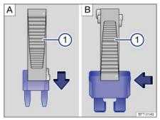
Abb. 012 Sicherung mit der Klammer der Kunststoffzange 1 entnehmen oder einsetzen.
