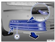
Abb. 015 Im Stoßfänger vorn rechts: Abschleppöse einschrauben.
