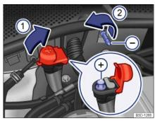
Abb. 013 Im Motorraum: Starthilfepunkte Pluspol + und Masseanschluss -.
