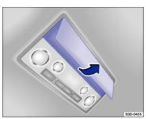
Abb. 005 Im Dachhimmel hinten: Abdeckung herunterklappen.
