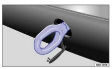
Abb. 016 Im Stoßfänger hinten rechts: eingeschraubte Abschleppöse
