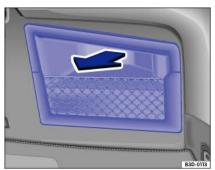
Abb. 007 Im Gepäckraum rechts: Staukasten ausbauen.
