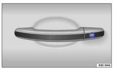
Abb. 001 Türgriff an der Fahrertür: Schließzylinder.
