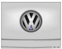
Abb. 004 An der Gepäckraumklappe: Schließzylinder im VW-Emblem.
