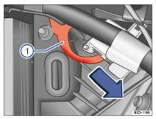
Abb. 008 Im Gepäckraum rechts: Notentriegelung der Tankklappe
