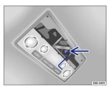
Abb. 006 Im Dachhimmel hinten: Handkurbel eingesteckt.
