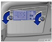
Abb. 010 Im Gepäckraum links: Abdeckung des Sicherungskastens entfernen.
