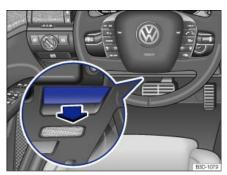
Abb. 009 Im Fahrerfußraum: Entriegelungshebel für den Sicherungskasten.
