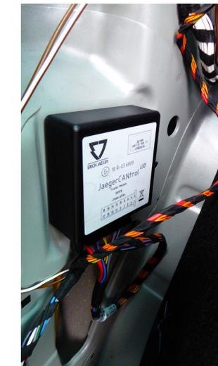
**Schritt 11:** Weiter geht's mit der Verlegerei nach Vorne. Die Radkasten Verkleidung muss abgenommen werden. Bzw. nur soviel aufgehebelt werden bis man den Kabelbaum durchführen kann. Die Einstiegsleisten vorne und hinten sind auch nur geclipst. Einfach dran ziehen. Kabelbaum durch und wieder festklopfen mit der Faust.
