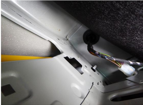
**Schritt 9:** Wenn das ein Ende vom Kabelbaum Draußen ist, dann das Kabel zur Steckdose führen und anschließen. Leider ist Kein Durchgang in der Nähe der Steckdose von VW geplant worden. Daher muss das Kabel entlang des Trägers gelegt und mit Kabel angebunden werden.
