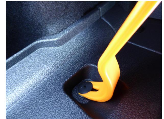
**Schritt 8:** Kabelbaum vom Kofferraum nach Außen führen. Dabei erst die linke Verkleidung (geclipst) abziehen. Danach den Teppich an den 3 markierten Stellen lösen. Muss man wenig dran ziehen und drehen. Unter dem Teppich sieht man einen schwarzen Stöpsel der nach Draußen führt. Mit einem flachen Schraubendreher einfach abhebeln.
