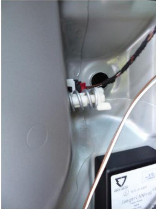
**Schritt 2:** Schrauben an der Schürze lösen. Es sind insgesamt 6 Torx-Schrauben die man lösen muss. Dazu kommt noch der Stecker der Rückfahrsonnen der rechts unten sitzt.
