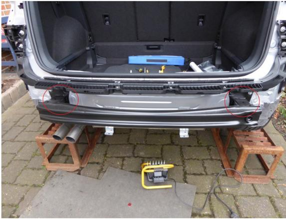
**Schritt 6:** An Stelle des Trägers kommt jetzt der Träger für die abnehmbare AHK ans Auto. Dabei einfach den Träger in die beiden Löcher Stecker die zum Vorschein kommen nachdem der original Träger entfernt wurde. Als Hilfestellung: der Träger sollte ca. 14 cm rausgucken. Danach den Träger mit den beige-lieferten Schrauben festdrehen. Anschließend kann schon mal der Halter für die Steckdose montiert werden.
