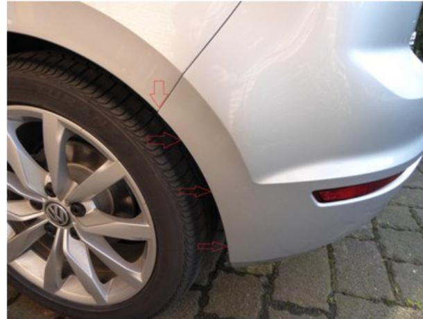
**Schritt 4:** Oben ist die Schürze geklippt. Einfach an den markierten Stellen mit einem Schlitzschraubendreher die Clipse eindrücken und danach leicht abziehen.
