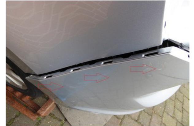
**Schritt 5:** Stoßstange entfernen. Hierbei rechts und links die Schrauben lösen und den Träger abnehmen. Keine Angst. Der Träger fällt nicht nach der letzten Schraube runter. Ist noch eingehakt. Einfach nach oben hin wegziehen.
