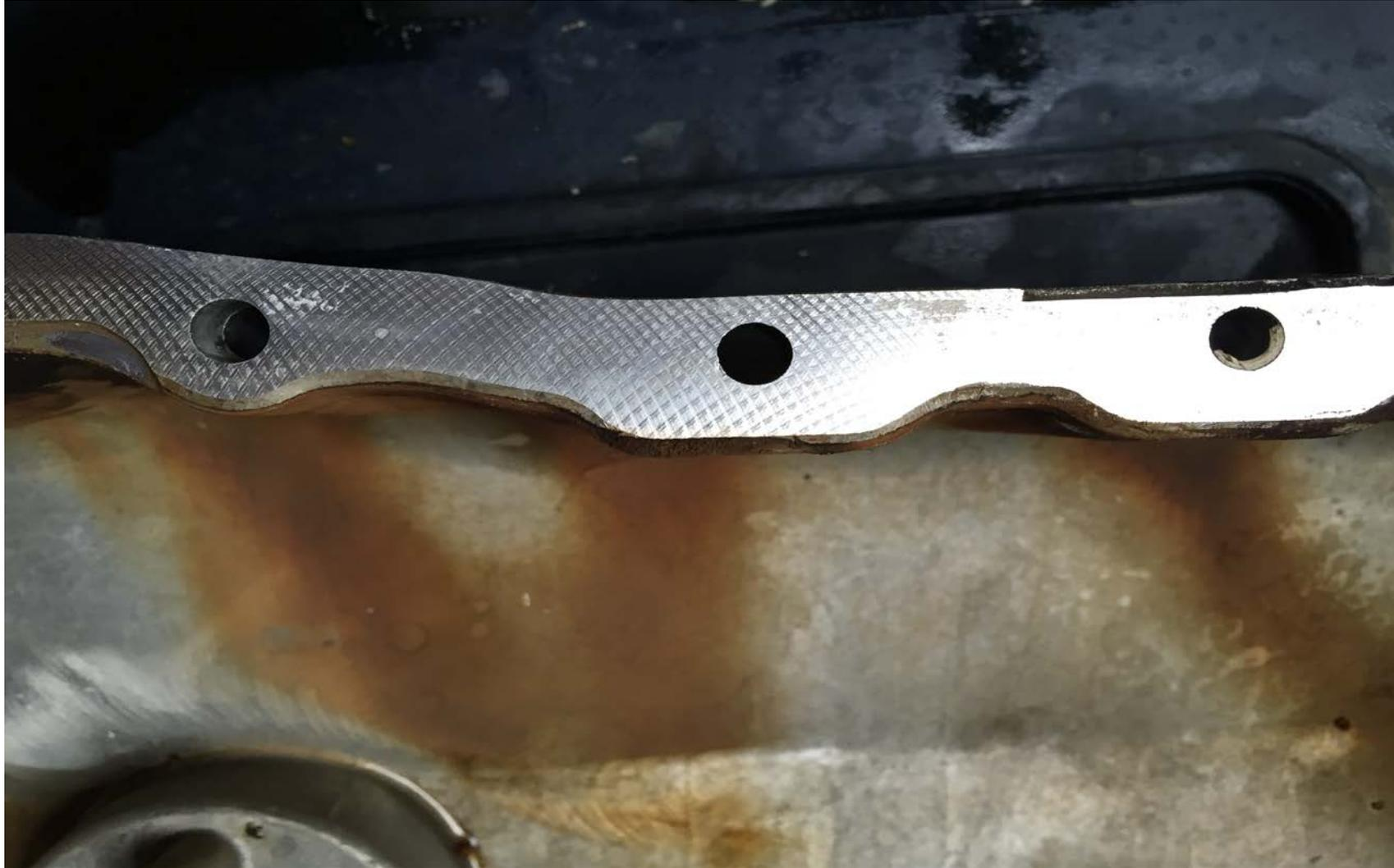
Auf dem Bild seht ihr, dass die Dichtungsmasse durch die Rillen angepresst wird. Hierdurch wird gewährleistet, dass keine Ritze ohne Masse bleibt.
