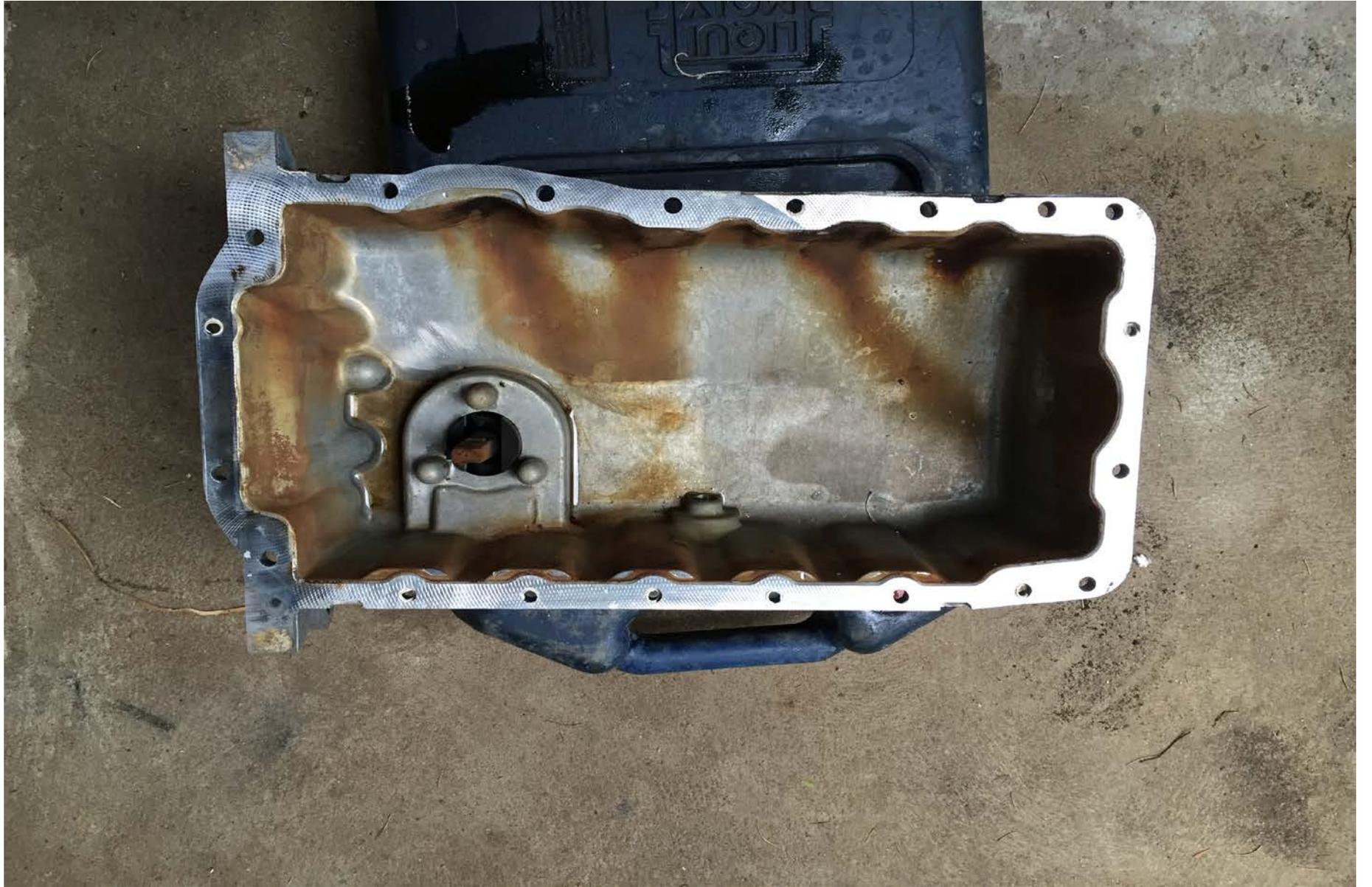
3. Nun müsst ihr die alte Dichtung von der Ölwanne sowie am Motorblock entfernen. Hier hilft Bremsenreiniger und Stofftücher. Teilweise muss man fester Schrubben, damit es abgeht. Hinterher muss es so aussehen:
