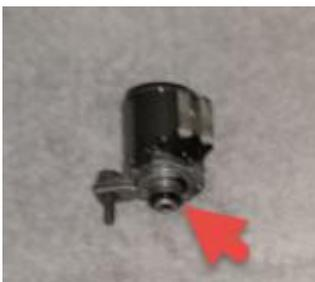
12. N88, N89, N90 und N91 ausbauen, **Achtung beim Ausbauen bleiben ein Plättchen und eine Kugel magnetisch am Ventil hängen**, nun vorsichtig die Feder und die beiden Dichtringe entfernen
