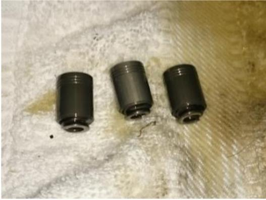
14. Im Unterteil die beiden Dichtringe, die 13 Feinsiebe, die zwei Aluplättchen samt Kugeln entfernen.
