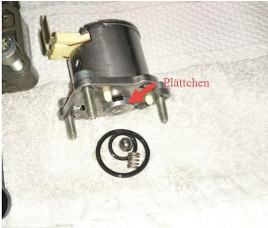
13. Alle übrigen Schrauben entfernen danach lässt sich das Oberteil vom Unterteil ohne Probleme trennen. **Achtung das Unterteil nicht umdrehen**. Die Schraube der Dichtung des Oberteiles entfernen nun kann die Dichtung abgenommen werden. **Achtung Oberteil nicht umdrehen ansonsten fallen dann drei kleine Kolben raus**.
