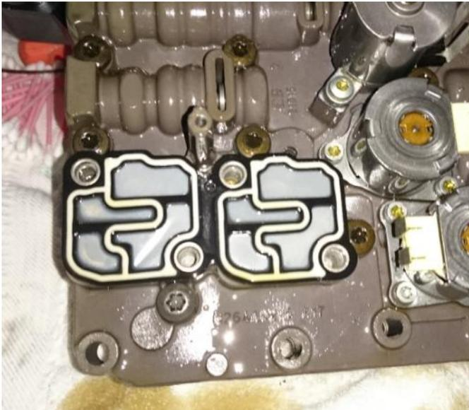
10. Ventil N92 entfernen **Achtung** unter N92 ist ein Plättchen, eine Kugel und zwei Dichtringe, **!!!Feder ist dort nicht Fehler von mir!!!**
