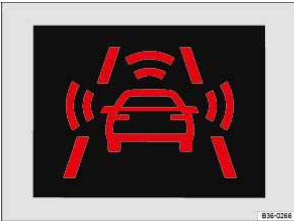
Abb. 3 Im Display des Kombi-Instruments: Vorwarnungsanzeige.
