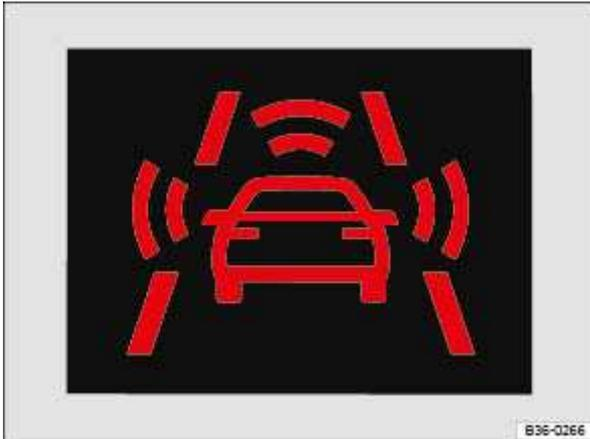
**Abb. 2** Im Display des Kombi-Instruments: Vorwarnungsanzeige.
