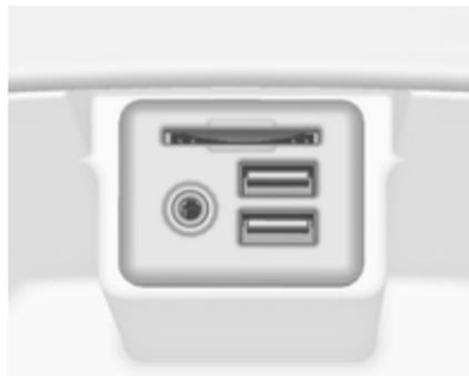
Unter der Armlehne in der Mittelkonsole befinden sich ein AUX-Eingang, ein USB-Anschluss und ein SD-Kartenleser zum Anschluss externer Geräte. Ausführliche Anweisungen zum Anheben der Armlehne finden Sie in der Betriebsanleitung.
