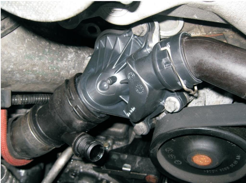
Ich habe einfach mit einem Holzstiel den linken Schlauch nach hinten gedrückt und mit der anderen Hand am Anschluss gewackelt. So konnte ich den Schlauch gut vom Thermostat lösen. Die andere Seite mit dem festen Kunststoffrohr habe ich einfach ganz vorsichtig zu mir gebogen und das Thermostat dann raus gekantet. Aber Vorsicht ... das Rohr kann leicht beschädigt werden.
