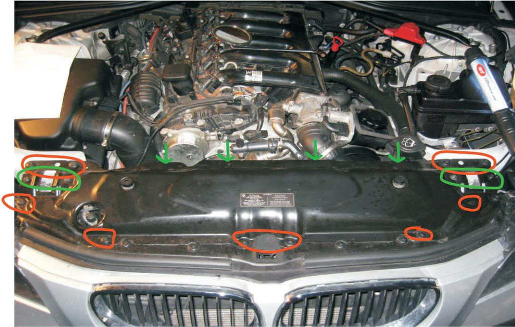
3. Nun wird die Abdeckung des Lüfters abgebaut.
