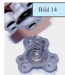
muss vorsichtig demontiert werden. Prüfen sie die Membran auf Risse und Verharzungen. Beim geringsten Verdacht auf Fehler ist es ratsam sie zu tauschen. Ist sie o.k. kann das Ventil wieder geschlossen und anschließend der Freigang des Ventils durch einfaches Anheben und
