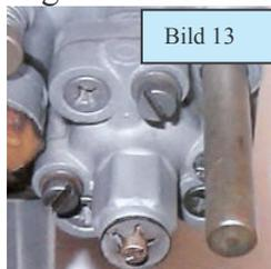
So, nun aber zu Demontage. Wie schon gesagt, drehen sie erst die Schlitzschrauben auf und nehmen das Ventil ab. Bild 13 zeigt ein moderneres Ventil mit internem Unterdruckröhrchen. Erst dann werden die 3 Kreuzschlitzschrauben abgedreht und das Ventil geöffnet. Achtung das Ventil ist federgespannt. Die Membran ist in ein Dichtungspaket eingepackt, und
