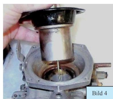
hoben werden. Bitte darauf achten, dass der Kolben gerade heraus gezogen wird, um die Nadel nicht zu verletzen. Werden die vier Schrauben auf der Oberseite der Membran gelöst, kann die Membran samt den beiden Scheiben abgenommen werden. Prüfen sie die Membran sorgfältig auf Risse, Verunreinigungen und Verharzungen. Beim leisesten Zweifel, dass sie beschädigt sein könnte, sollte sie ausgetauscht werden.
