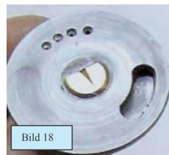
Instandsetzen lässt sich an diesem Bauteil eigentlich nichts. Es sollten lediglich alle Bohrungen gesäubert werden. Danach kann die Kaltstarteinrichtung, mit neuer Dichtung versehen, wieder auf das Vergasergehäuse montiert werden.
