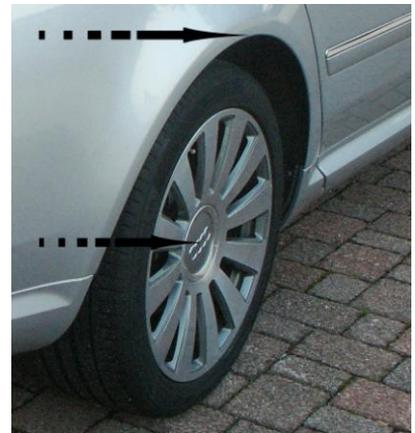
Zur Sicherheit führen Sie diese Messung in regelmäßigen Abständen von max. 6 Monaten durch. So können Sie einen Luftverlust rechtzeitig feststellen und beheben, bevor Schäden an Bauteilen (Kompressor, Ventileinheit) entstehen.
