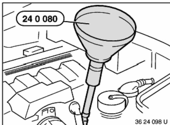
Mit Spezialwerkzeug 24 0 080 Automatic-Getriebeöl auffüllen.
