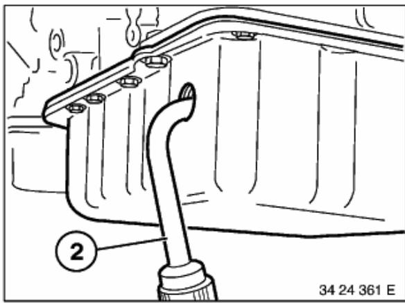
Zum Auffüllen Füllstutzen (2), in die Einfüllöffnung einhängen.
