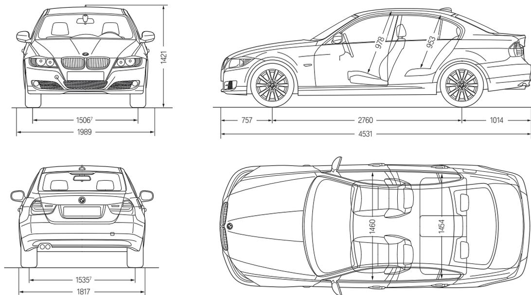
Alle Maßangaben der technischen Zeichnungen in Millimeter. Gepäckraumvolumen 460 l, für 335i und 335d 450 l (VDA-Messung).
