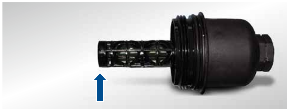
Abb. 2: Bruchstelle am Kunststoffrohr, der Verschluss für das Drainageventil fehlt
