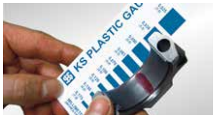
Prüfung des Gleitlagers mit „KS Plastic Gauge“
