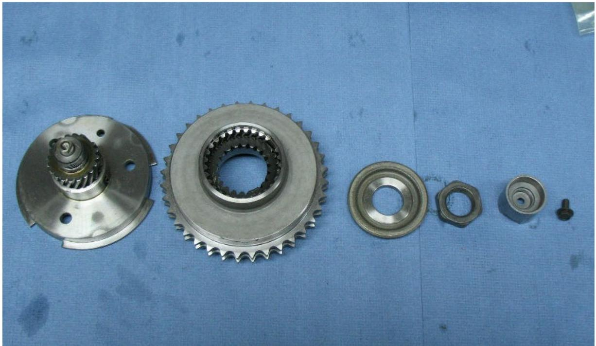
eingebauter Flansch vom linken Nockenwellenversteller
