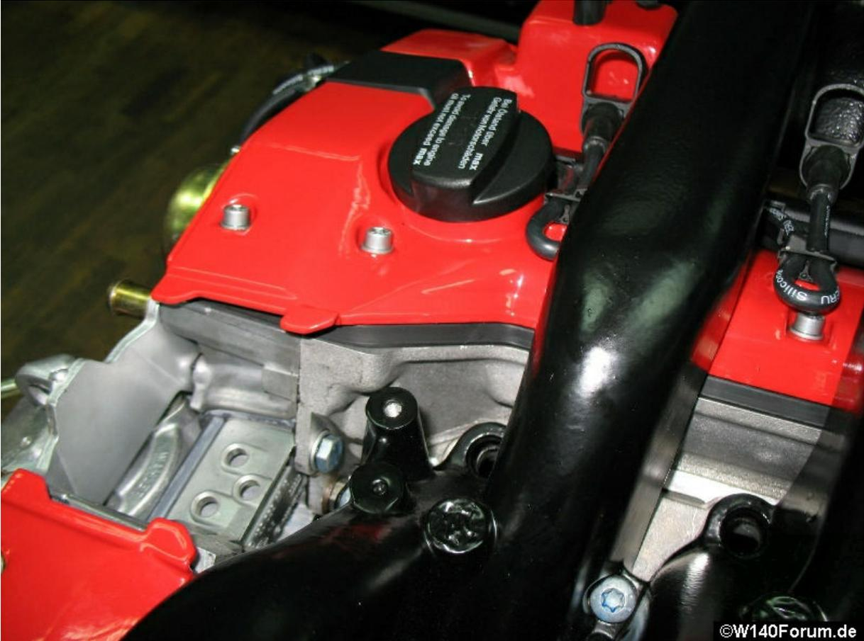
Motor weiter komplettiert mit Riemenscheiben, Schutzhauben usw.
