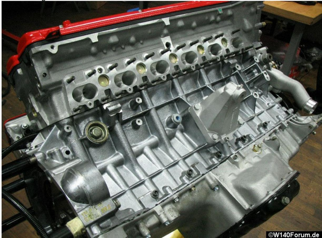
Hier nochmals ein paar Einblicke in die Auslasskanäle mit den Auslassventilen
