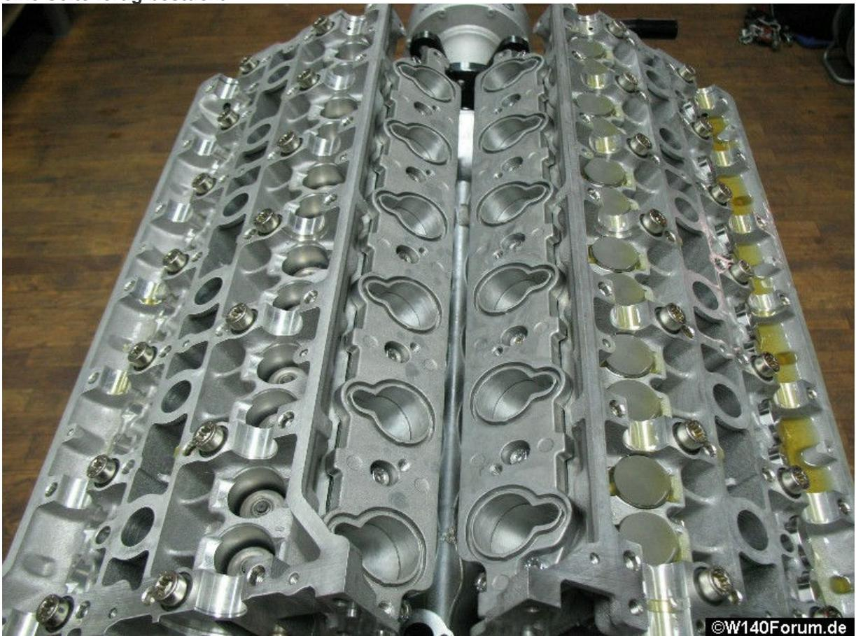
Fertig bestückt mit insgesamt 48 Hydros
