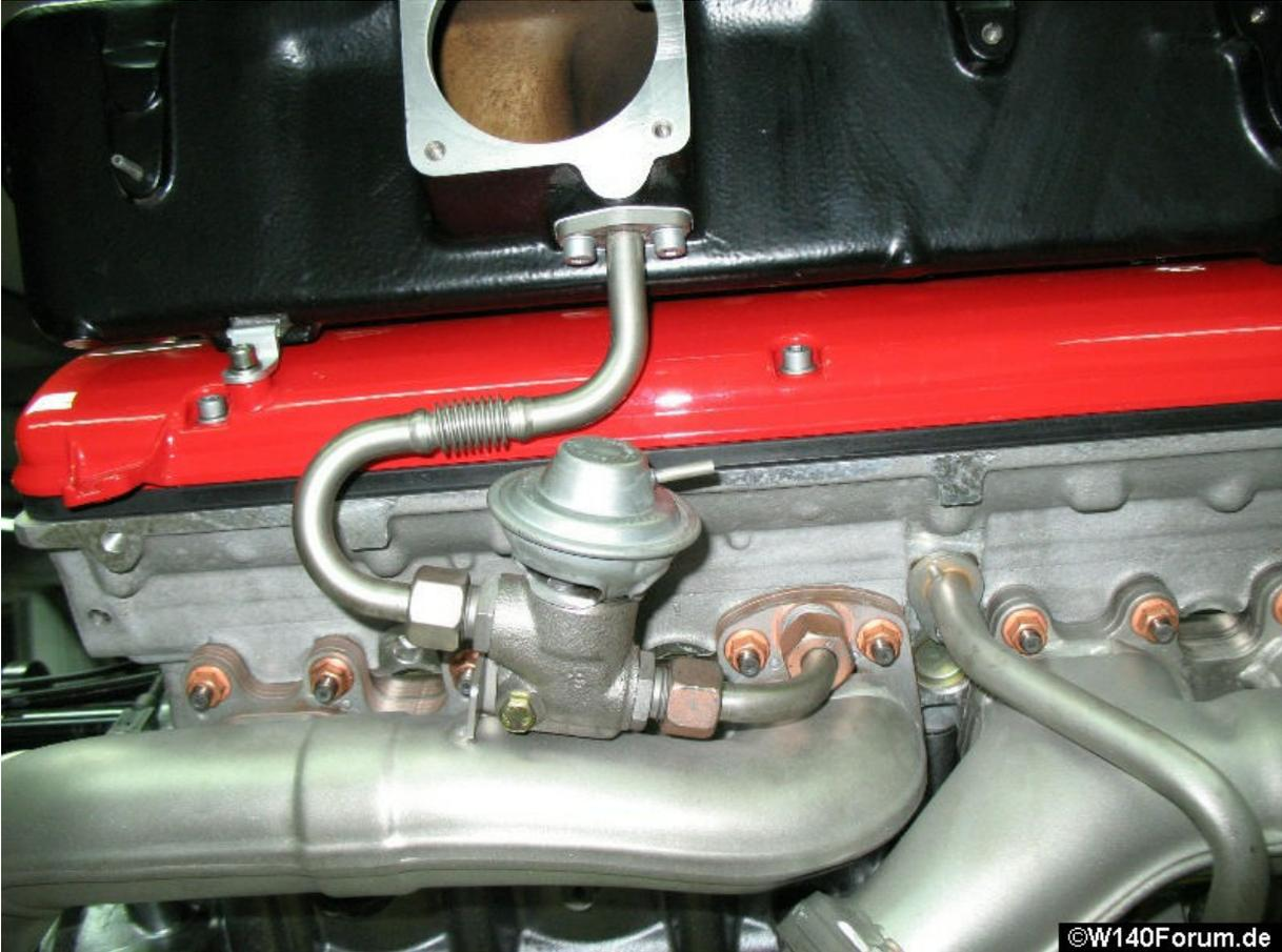
Einbau der Drosselklappenteile
