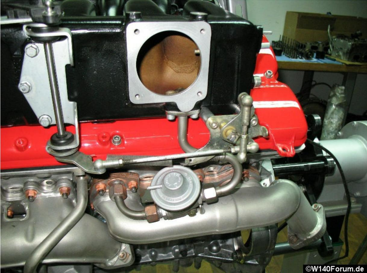
V12 Motor mit angebauter linker Drosselklappe
