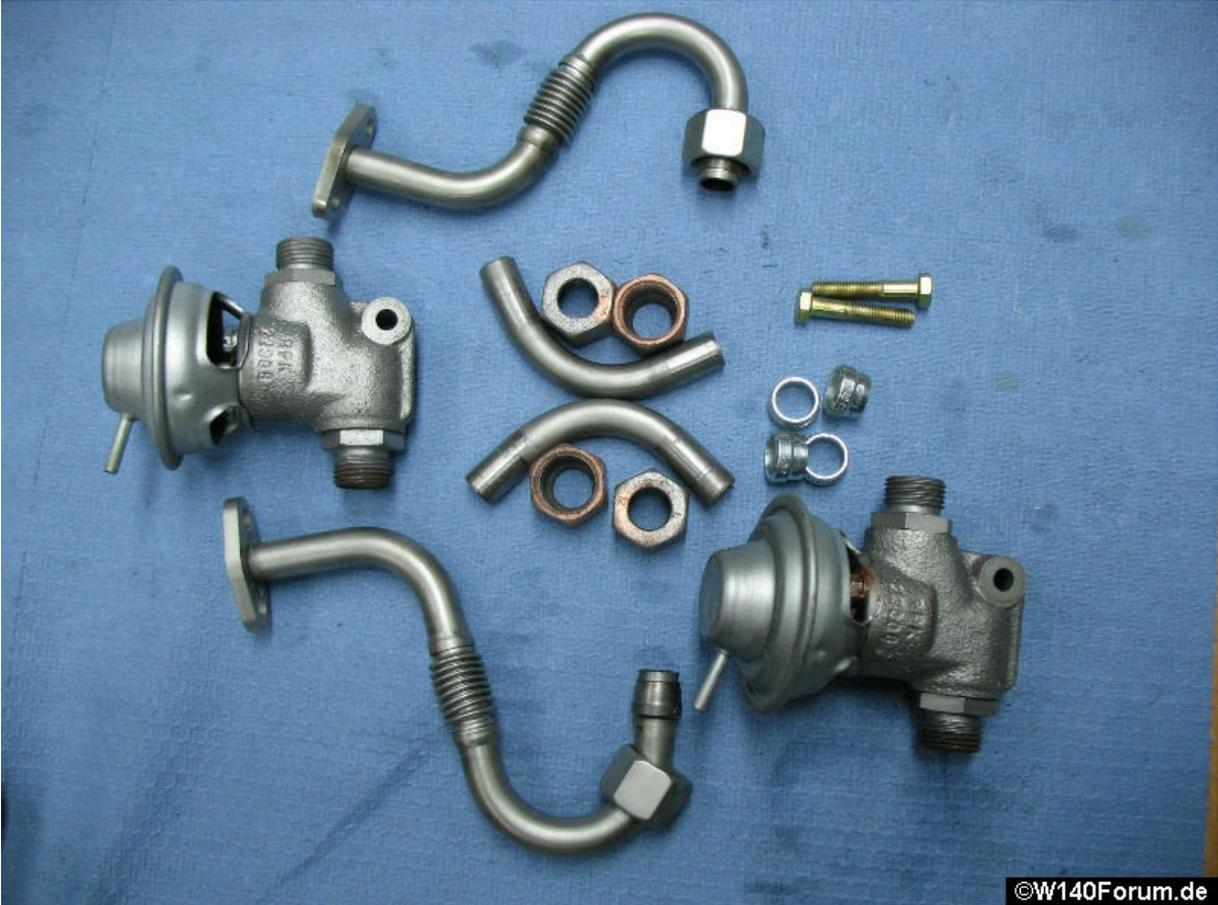
Einbau der Abgasrückführung
