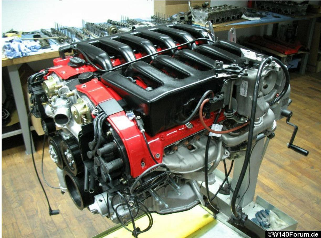
V12 Motor mit angebauter rechter Drosselklappe
