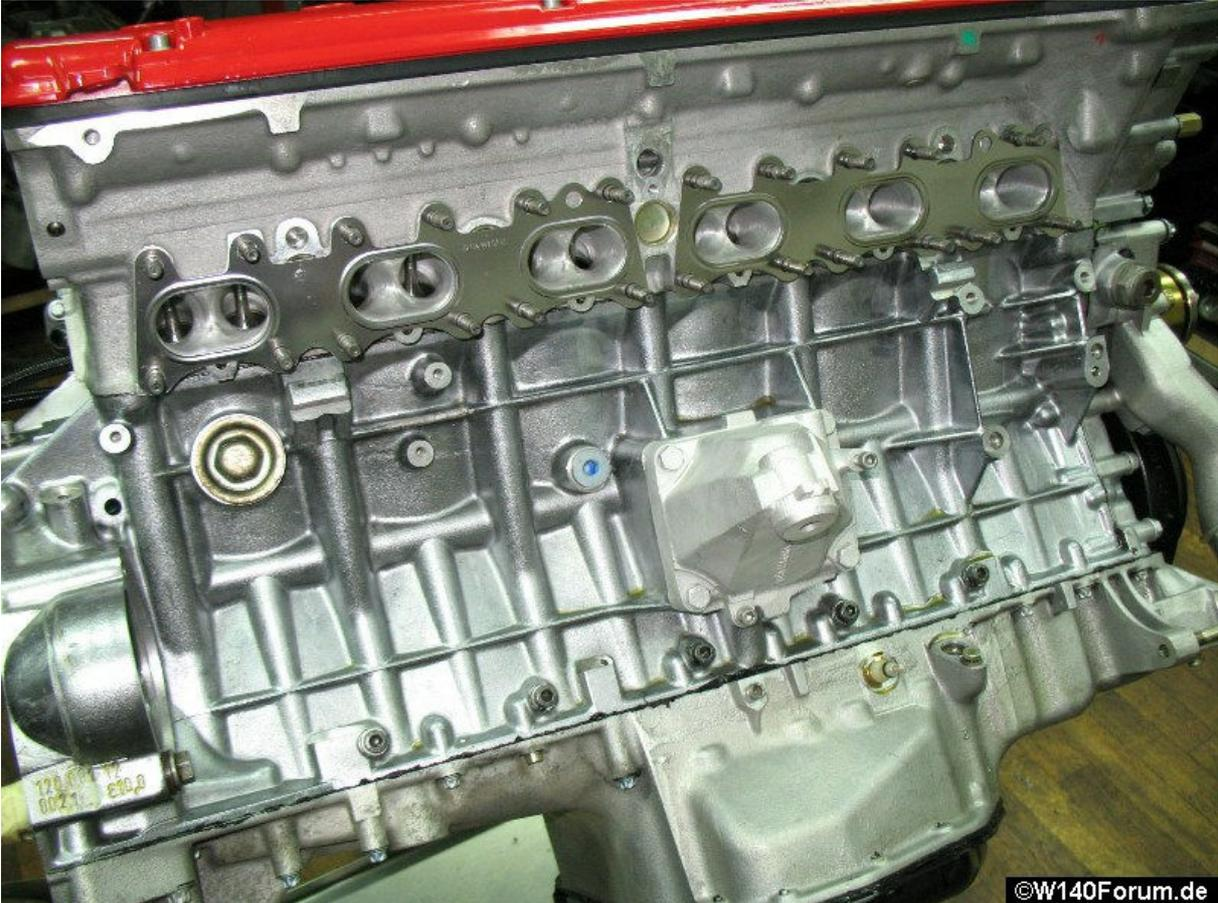
Auslasskanal ist bis zur Dichtung komplett ausgereizt
