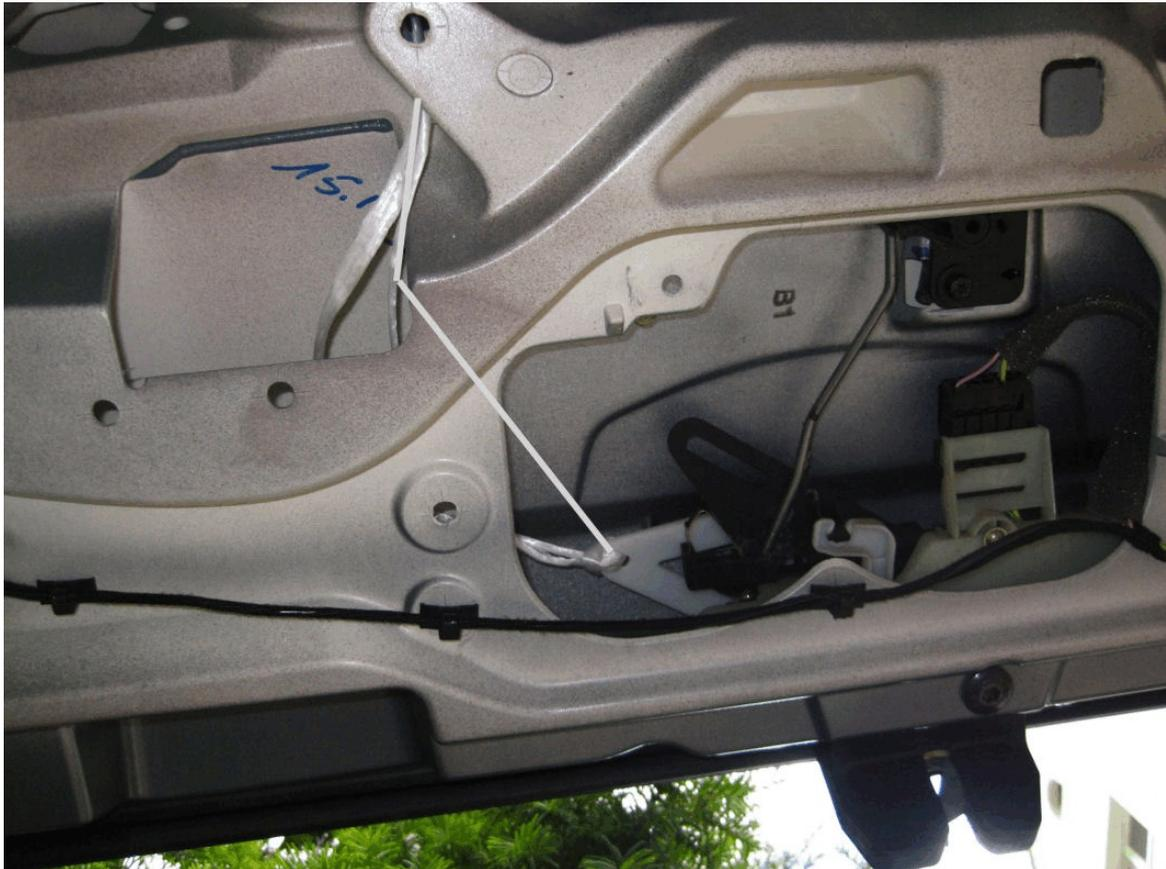
Die gerade Linie ist der Verlauf des gestrafften Seiles bei Zug. Der weiße Hebel hier im Bild ist in der oberen Stellung (Öffnergriff wirksam). Das Seil muss in der Heckklappe locker liegen, um die elektrische Schließung nicht zu behindern (Der Hebel bewegt sich dabei nach unten!).
