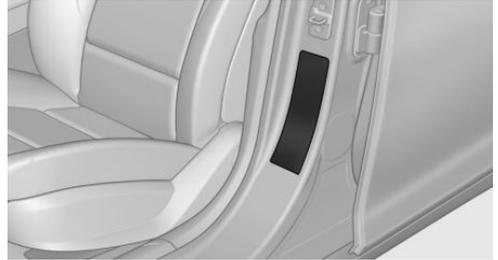
Die Druckangaben für freigegebene Reifengrößen befinden sich an der Türsäule der Fahrertür.
