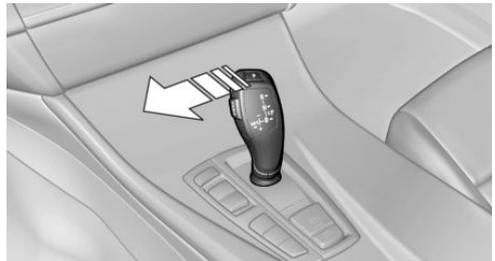
Wählhebel aus Getriebeposition D nach links drücken.
