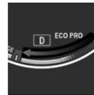
Im Drehzahlmesser zeigt ein langer Pfeil bis zum Nullpunkt der Balkenanzeige an, dass ein vorausliegender Streckenabschnitt erkannt wurde.
