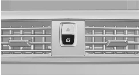
Durch Drücken der Taste werden die Türen und die Kofferraumklappe bei geschlossenen Vordertüren ver- oder entriegelt, aber nicht diebstahlsicher.
