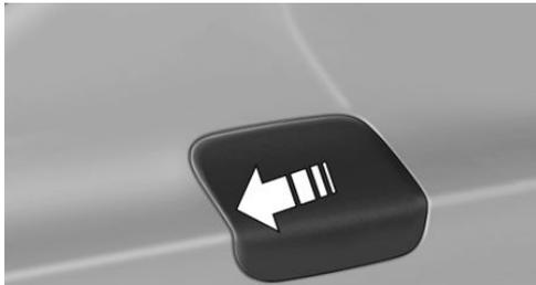
2. Tankverschluss gegen den Uhrzeigersinn drehen.
