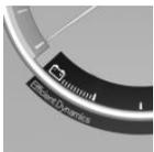
Bewegungsenergie des Fahrzeugs wird bei Schubtrieb in elektrische Energie umgewandelt. Die Fahrzeugbatterie wird teilweise aufgeladen und der Kraftstoffverbrauch kann gesenkt werden.
