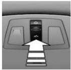
Schalter nach oben drücken und halten, bis die Initialisierung abgeschlossen ist:
