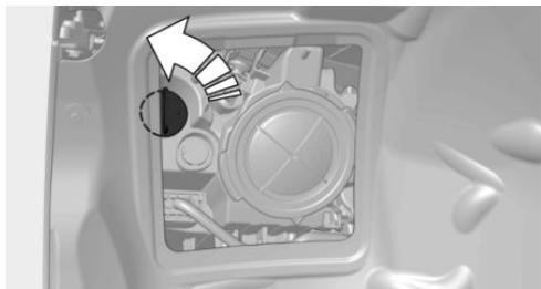
3. Lampe leicht in die Fassung drücken, gegen den Uhrzeigersinn drehen und herausnehmen.
