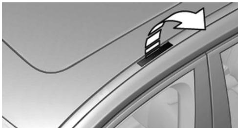
Die Aufnahmepunkte befinden sich in der Dachleiste oberhalb der Türen.
