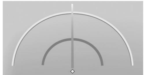
Die Entfernung des Anhängers zur Anhängerkupplung kann mithilfe zweier statischer Halbkreise abgeschätzt werden.
