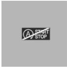
Die Anzeige signalisiert, dass die Voraussetzungen für einen automatischen Motorstopp nicht erfüllt sind.
