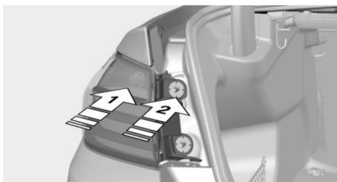
4. Heckleuchte mit den beiden Muttern anschrauben.
