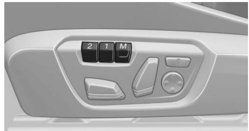
Zwei verschiedene Fahrersitz- und Außenspiegelpositionen können pro Fernbedienung gespeichert und abgerufen werden. Die Einstellungen der Lehnenbreite und Lordosenstütze werden nicht gespeichert.
