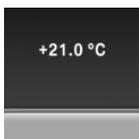
Falls die Anzeige auf +3 °C oder niedriger sinkt, ertönt ein Signal. Eine Check-Control-Meldung wird angezeigt. Es besteht erhöhte Glättegefahr.
