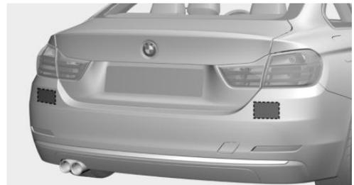
Die Radarsensoren befinden sich unter dem hinteren Stoßfänger.
