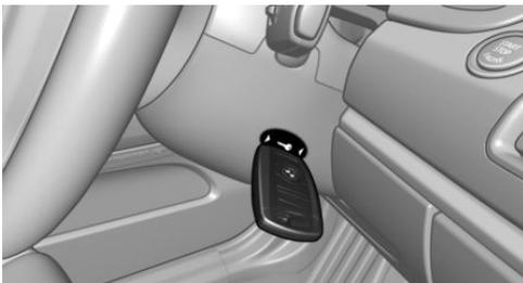
Automatic-Getriebe: Bei entsprechender Check-Control-Meldung die Fernbedienung, wie abgebildet, an die Markierung an der Lenksäule halten und innerhalb von 10 Sekunden
