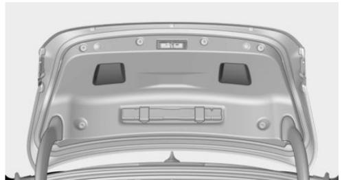
Griffmulden an der Innenverkleidung der Kofferraumklappe erleichtern das Herunterziehen.
