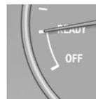
Die Anzeige READY im Drehzahlmesser signalisiert, dass die Auto Start Stop Funktion zum automatischen Motorstart bereit ist.
