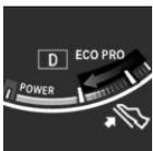
Der Pfeil zeigt an, dass die Fahrweise z. B. durch Gas wegnehmen verbrauchsgünstig angepasst werden kann.
