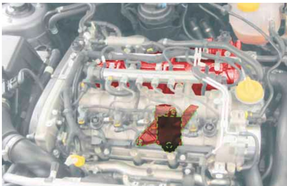
Motorraumbild Opel Vectra: Das Saugrohr mit AGR-Ventil ist rot hervorgehoben. Das Antriebsmodul befindet sich nicht sichtbar „hinter dem Motor“ und ist nur angedeutet (grüne Strichlinie).
