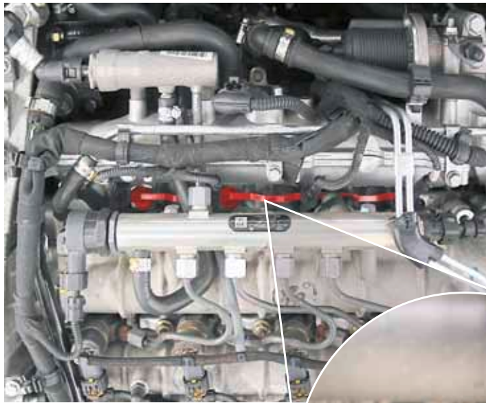
Schaltgestänge am Saugrohr im Opel Vectra (oben rot hervorgehoben und Detailansicht)
