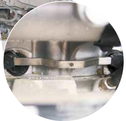
Schaltgestänge am Saugrohr im Opel Vectra (oben rot hervorgehoben und Detailansicht)
