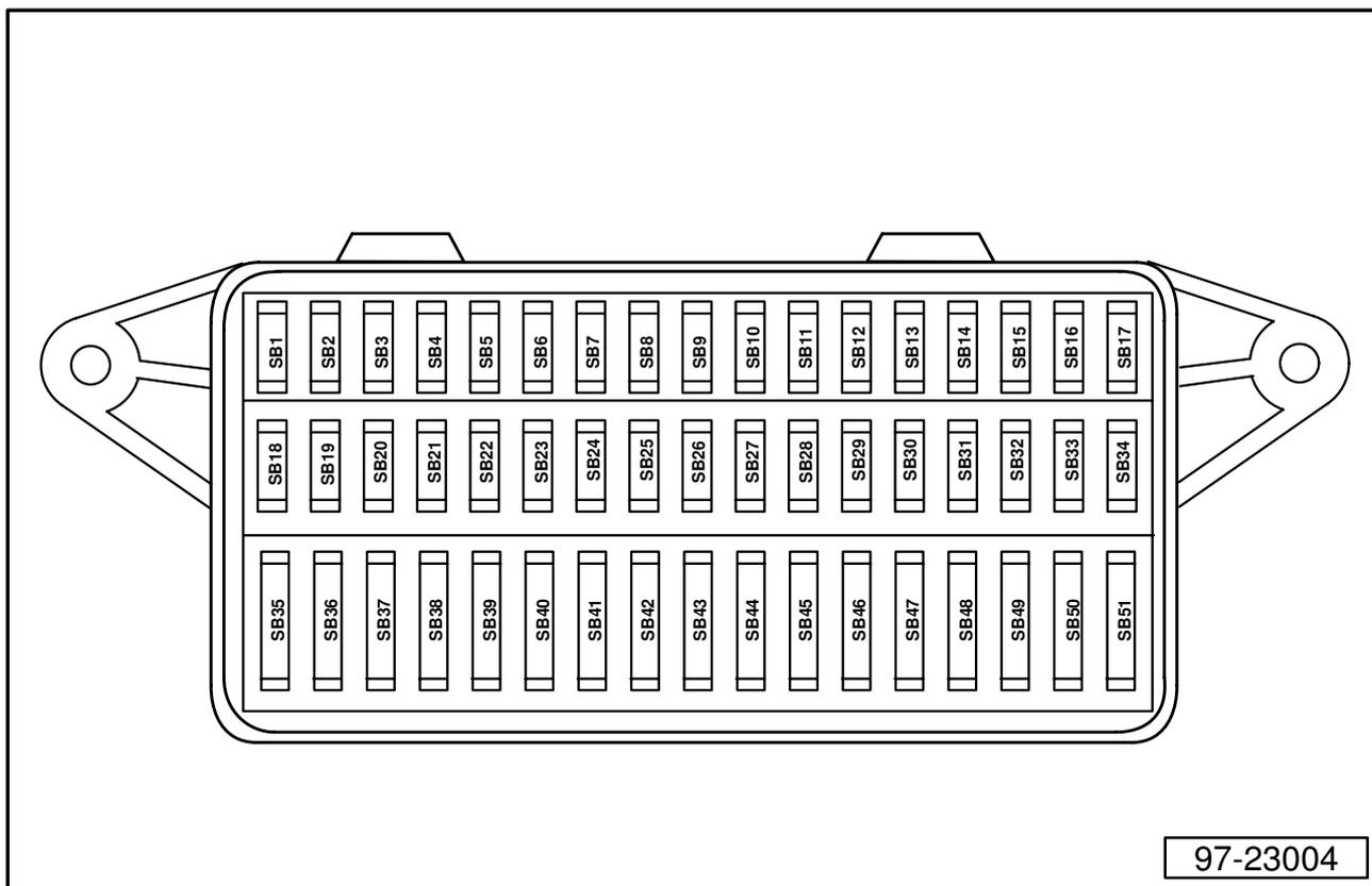
Die elektrischen Anschlüsse der Sicherungen sind aus den entsprechenden Stromlaufplänen ersichtlich.
