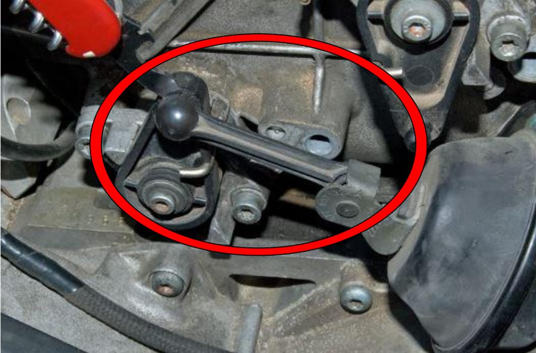
VORSICHT beim Ausbau des alten Hebels, den Gelenkteller nicht beschädigen! Etwas WD40 und ein Fön haben bei mir geholfen.
