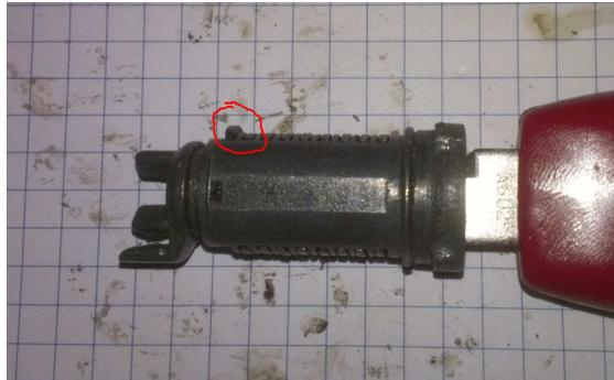
Abbildung 7: Passprobe, die markierte Sperrplatte passt nicht
