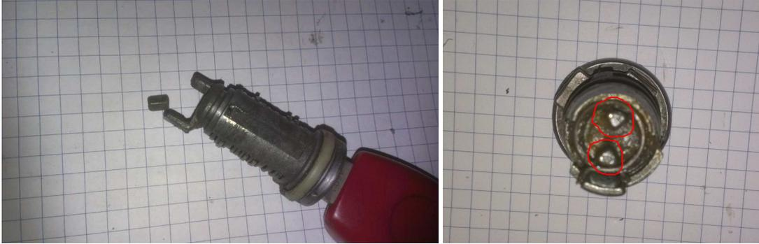
Abbildung 2: Schließzylinders links beschädigt, rechts intakt
