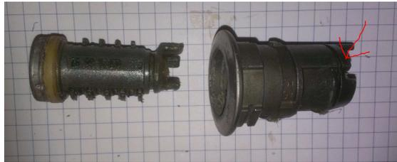
Abbildung 3: Kern und Mantel, an der Markierung saß die Feder
