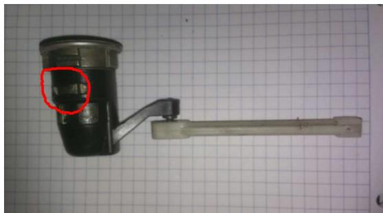
Abbildung 1: Schließzylinder komplett, Neuere Ausführung
