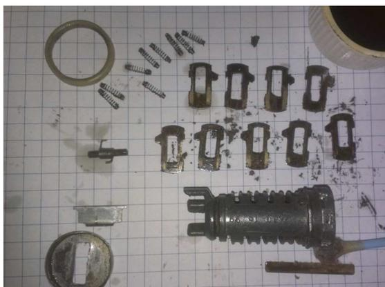
Abbildung 6: alle Einzelteile des Kerns
