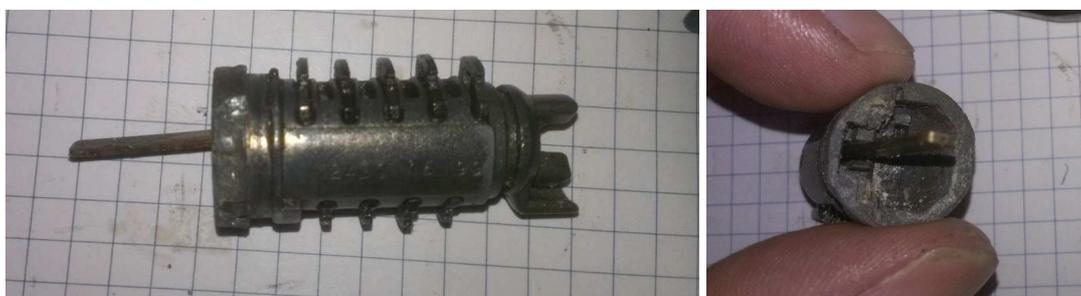
Abbildung 5: Sicherungsriegel ziehen
