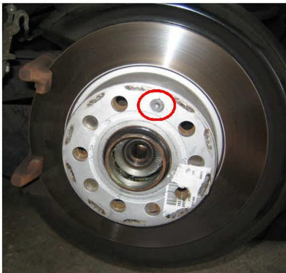
Die Bremsscheibe lösen und demontieren wir indem wir mit dem Torx Schraubendreher T30 die mit rotem Kreis markierte Zentrierschraube entfernen. Da die Bremsscheibe hier sehr neu verbaut war ging sie ohne weitere Hilfsmittel runter.
