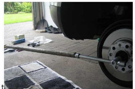
7. Nachdem die Nabenschraube gelöst ist kann man sich an den Bremssattel machen. Zur Demontage des Bremssattels löst bzw. entfernt man 2 Schrauben. Hierfür benötigt man 2 Maulschlüssel, und zwar einmal SW 13 und einmal SW 15 zum gegenhalten.
