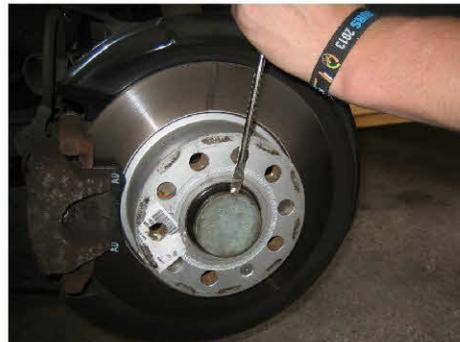
6. Nabenschraube lösen, vorher muss aber noch die Verschlusskappe beseitigt werden. Verschlusskappe kann mit Schlitzschraubendreher und Hammer demontiert werden. Zum Lösen der Nabenschraube benötigt man jetzt folgendes Werkzeug:
