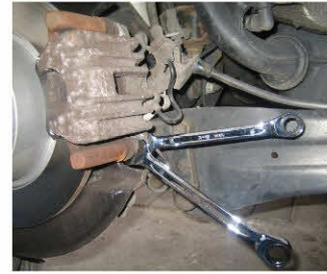
8. Nachdem der Bremssattel gelöst ist hängen wir ihn mit Hilfe einer Schnur so zur Seite das die Bremsleitung frei hängt und nicht auf Zug oder Verdrehung belastet wird.
