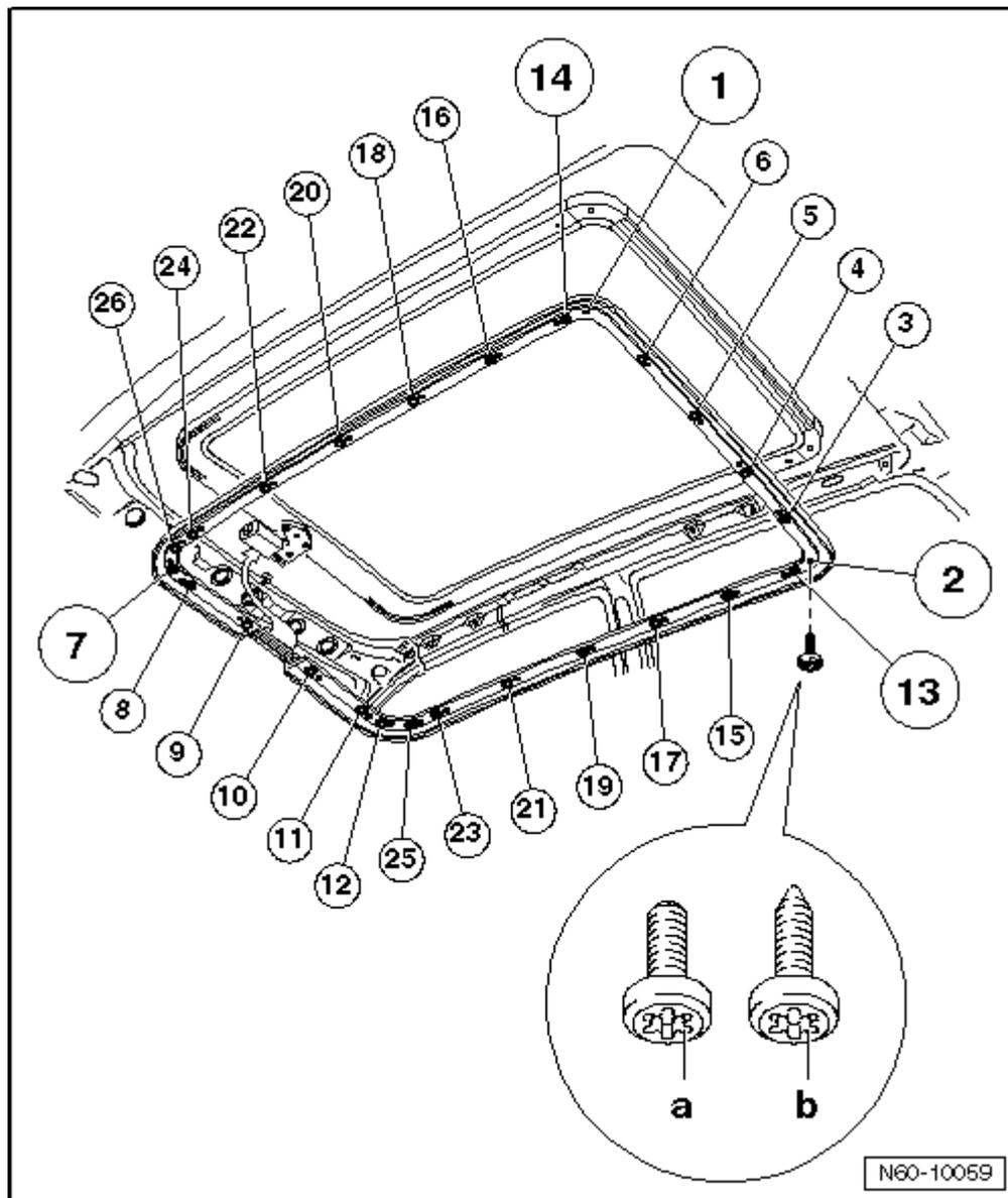
Die Reihenfolge in der die Schrauben -1 bis 26- festzuziehen sind, ist dem Bild zu entnehmen.
