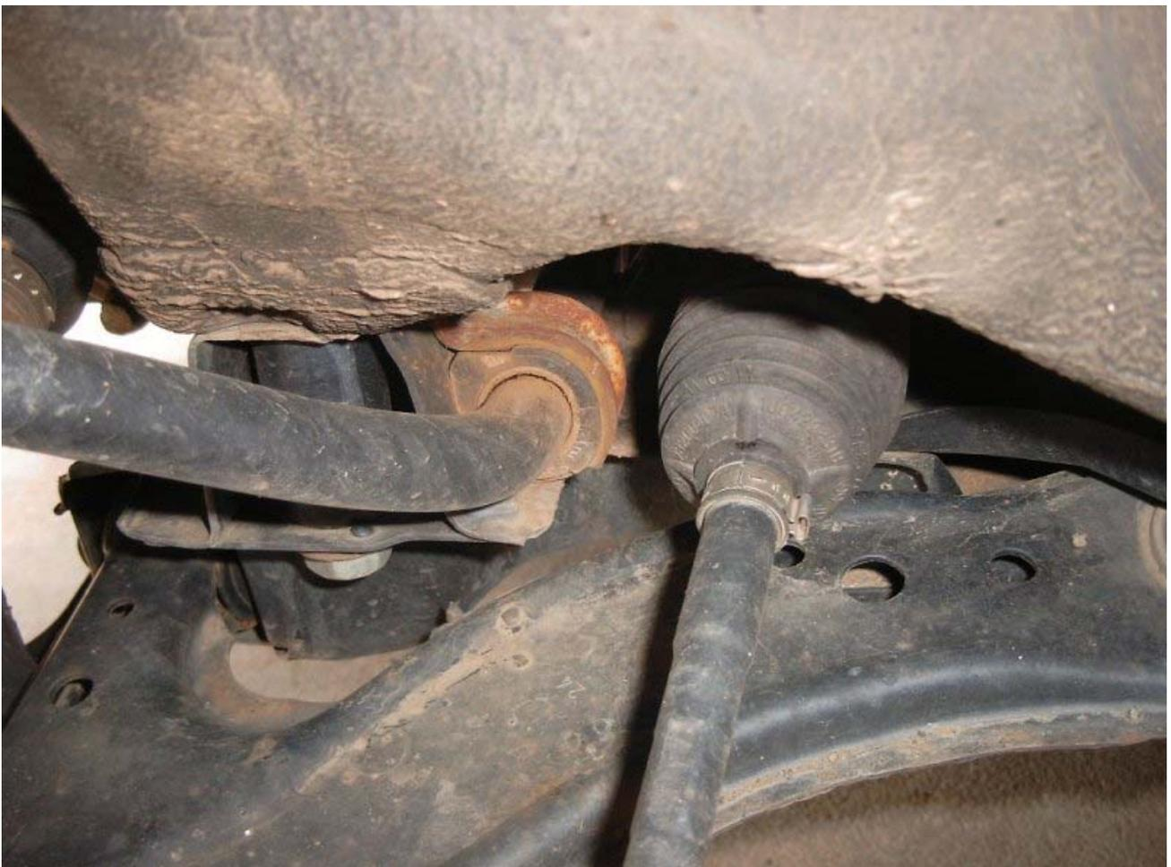
Gut zu erkennen: Das Gummi ist total ausgeschlagen, an der Oberseite ist ein Luftspalt zum Stabilisator. Bei Belastung, d.h. beim Überfahren von Schlaglöchern und Ähnlichem schlägt der Stabilisator in diesem Spalt hin und her. Dadurch entsteht dieses nervige Poltern, was wohl alle kennen, die dieses Problem haben.
