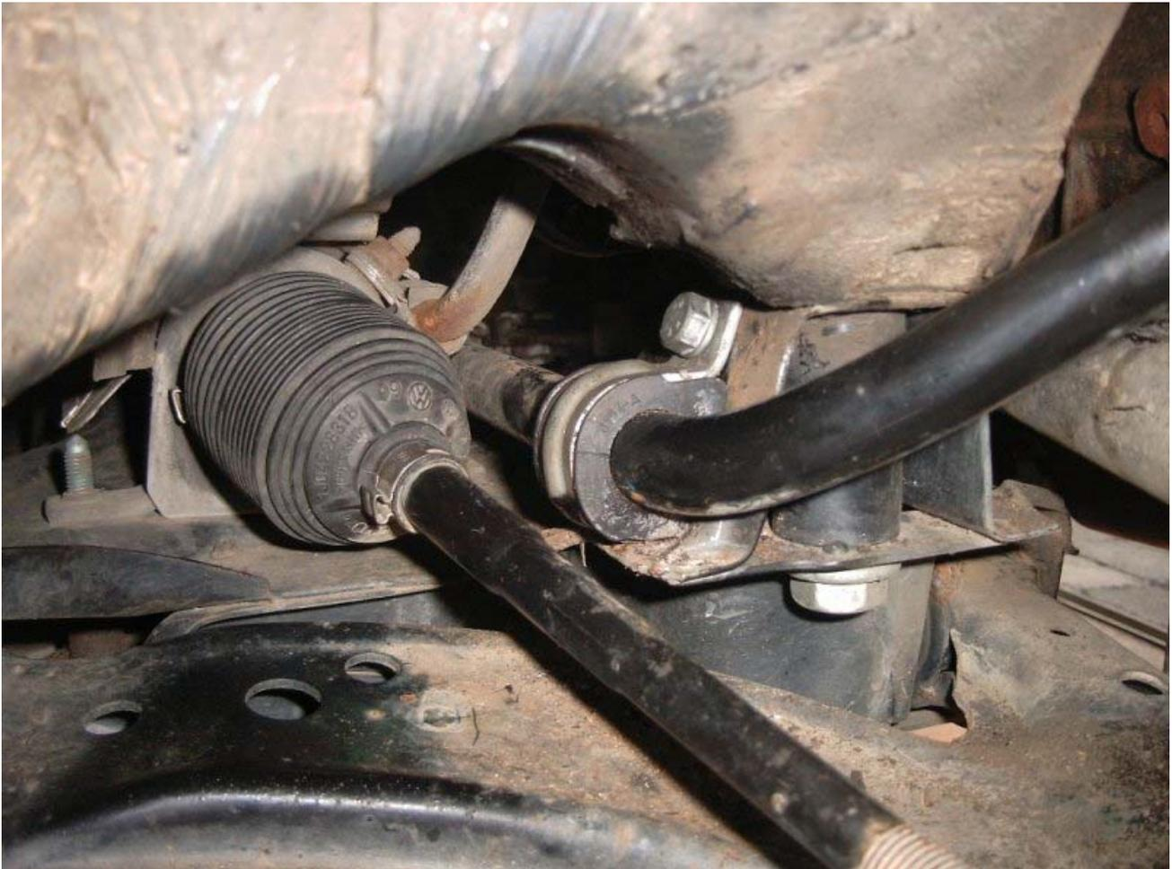
Das neue Gummi (hier auf der anderen Seite) in eingebautem Zustand. Es sitzt ohne irgendwo zu verklemmen absolut fest um den Stabilisator und dämpft damit jegliche Schwingungsübertragung auf das Chassis.
