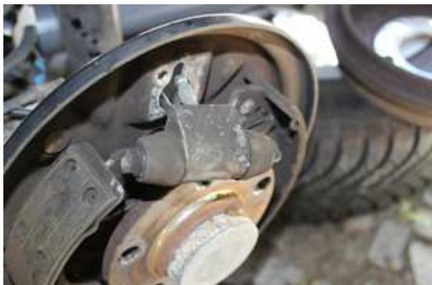
Wenn die Bremstrommel ab ist wird die Untere Feder an den Backen abgenommen.
