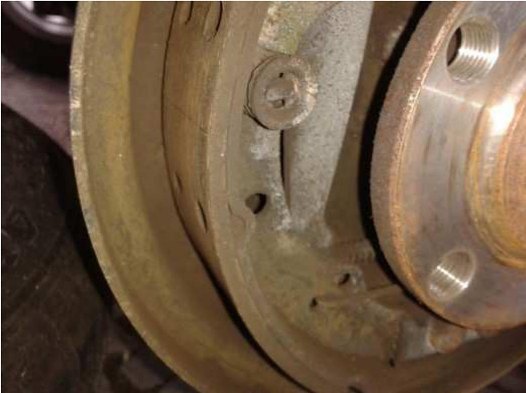
So jetzt wir der Nachsteller und alles was an den Backen ist auf die Neuen Backen montiert und in Umgekehrter Reihenfolge montiert den Rückstellkeil nicht vergessen.
