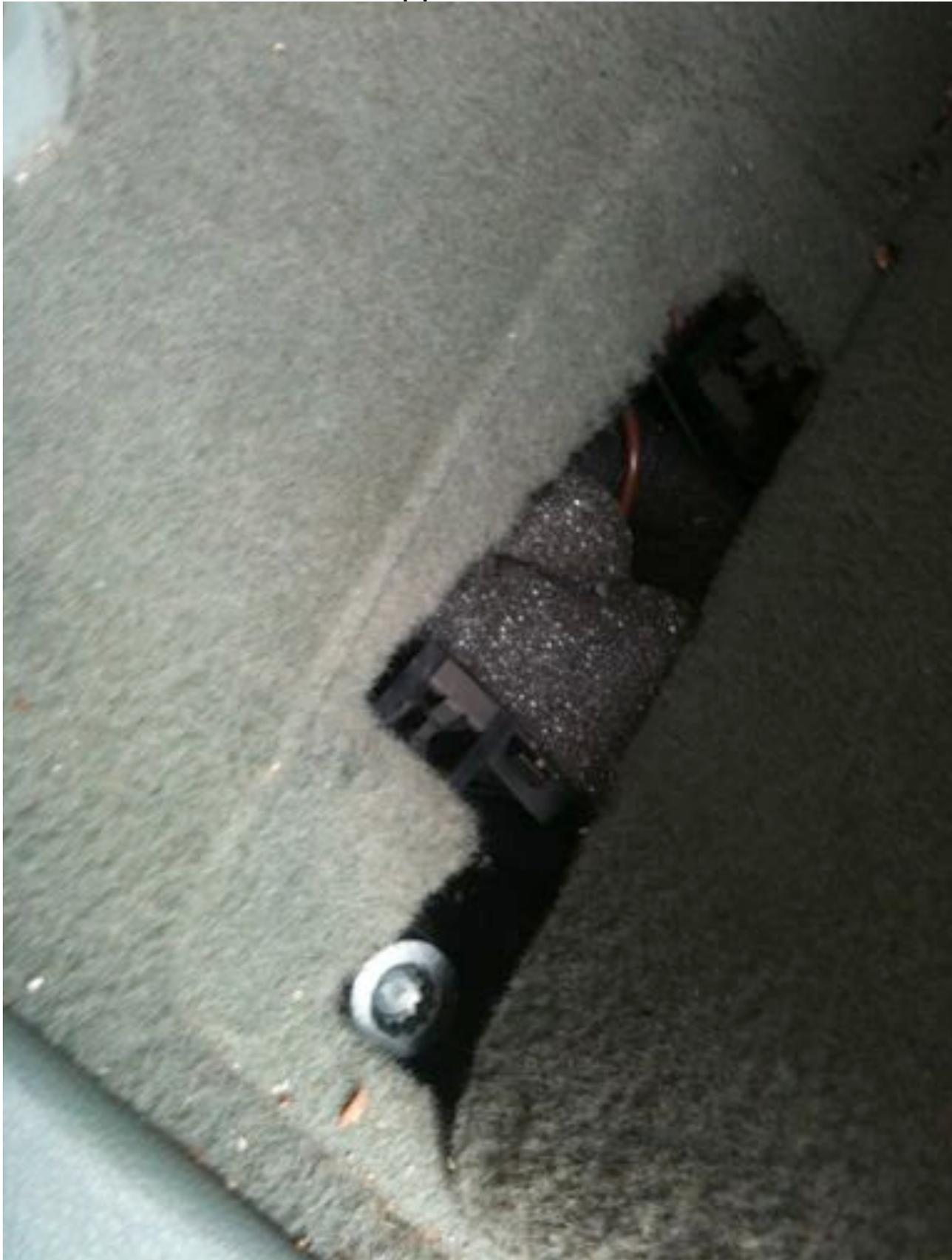
Batterieabdeckung abnehmen, Masse abschrauben, Plus abschrauben und Batteriehalterungen entfernen.
