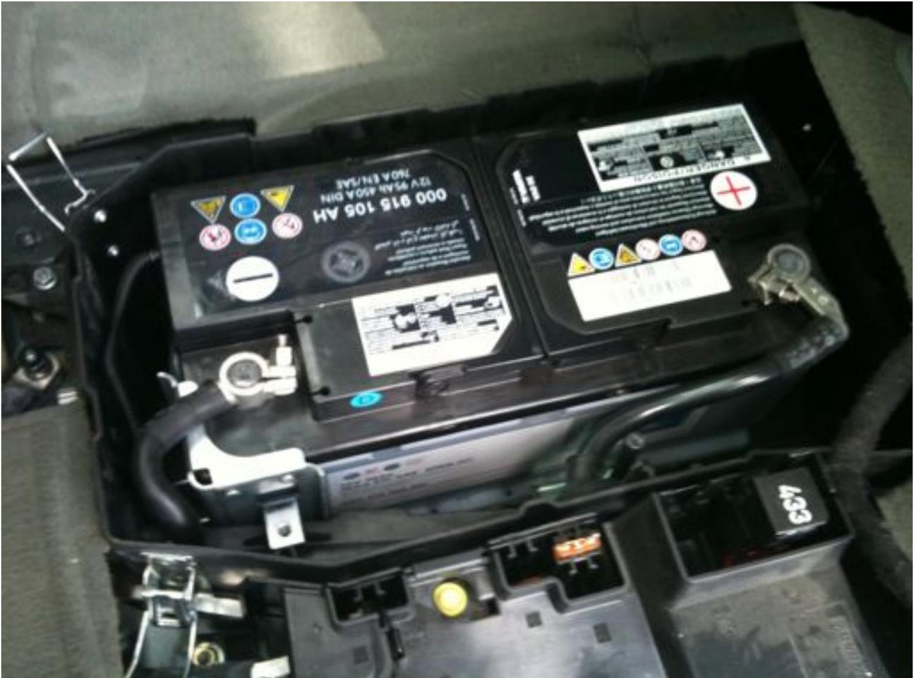
Neue Batterie rein und in umgekehrter Reihenfolge zusammenbauen.
