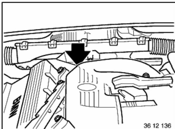
Anlasserschraube von Fahrzeugoberseite aus lösen.
