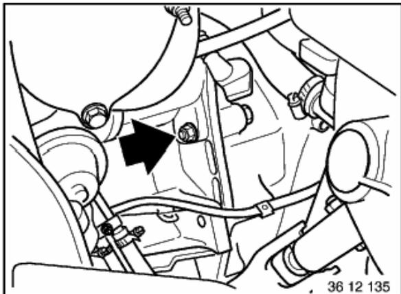
Anlasserschraube von Fahrzeugunterseite aus lösen.
