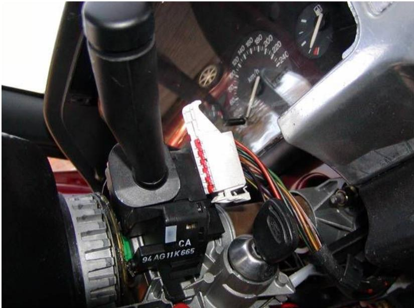
Der Schalter wird von nur einer Schraube oben gehalten. Nach entfernen den Schalter nach oben wegziehen:
