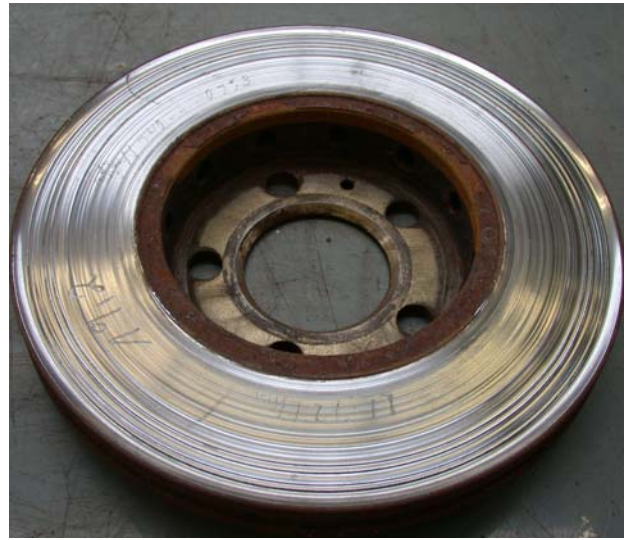
Bild2: Übersicht Bremsscheibe mit Riefen (VW)
