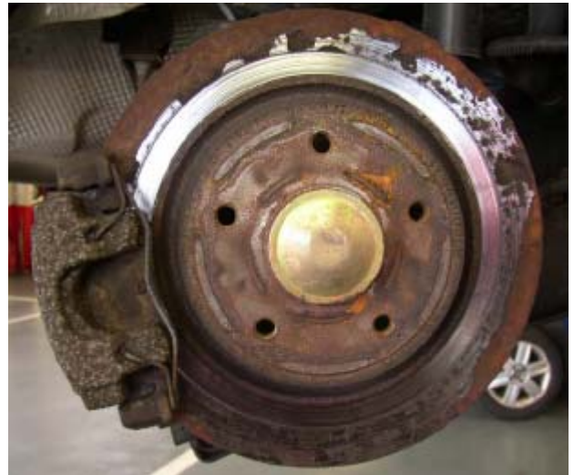
Bild 4: Unzulässig stark korrodierte Bremsscheibe (VW)
