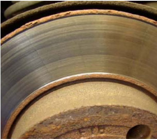
Bild 1: Aufoxidierte Ränder / Konturlinien (VW)
