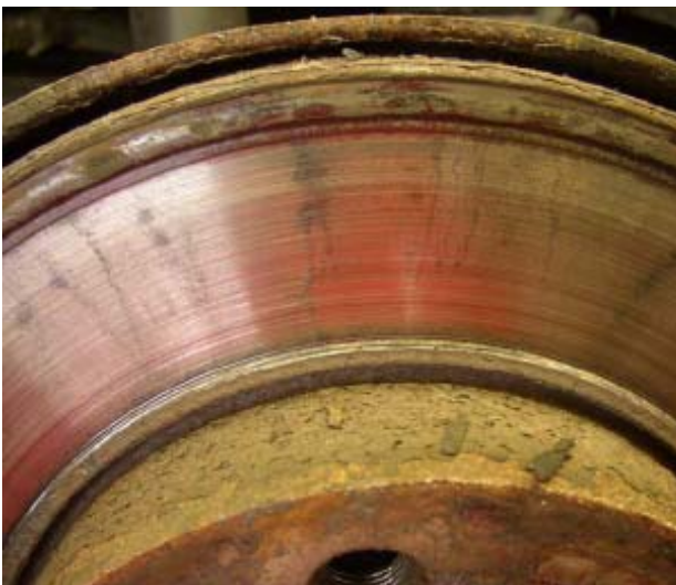
Bild 5: Gerade noch zulässige Bremsscheibenkorrosion (VW)
