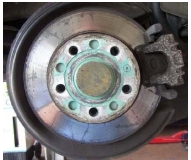
Bild 6: Fleckenbildung durch Ankleben von Bremsbelägen (VW)
