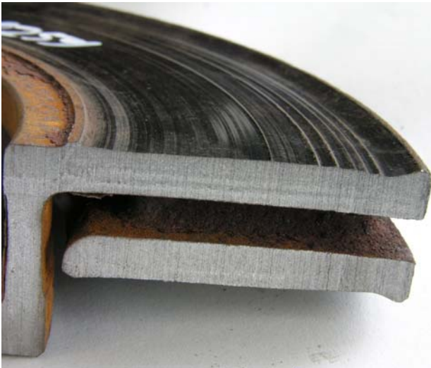
Bild 3: Bremsscheibe mit Riefen geschnitten (VW)
