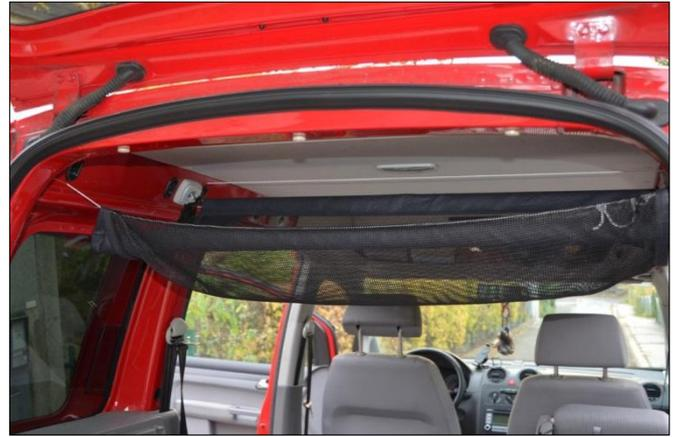
Die Netztrennwand wird über das quergespannte Seil geschlagen, die Haken am vorderen Seil eingehängt.
