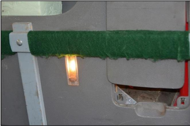
Der Zugang zum Seitenfach mit dem Wagenheber ist immer gewährleistet, der Deckel kann einfach herausgenommen werden.
