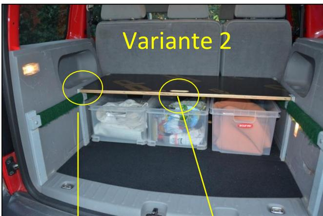
Die Dokaplatte ist nicht mit dem Träger verschraubt. Ausnehmungen der Platte sorgen für die Fixierung. Eine längliche Ausnehmung erleichtert das Anfassen der Platte (6,8 kg).
