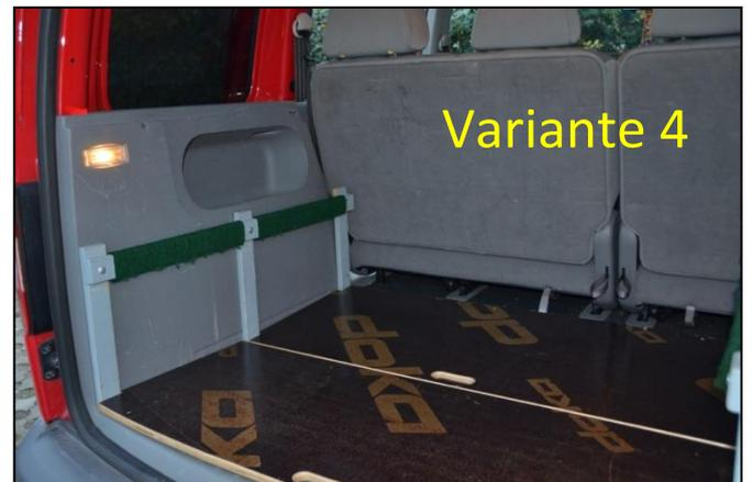
Die Träger sind mit einem grünen Filz umwickelt, der unangenehme Klappergeräusche verhindert. Auf eine rutschfeste Beschichtung der Platte wurde bewusst verzichtet. Oft ist es angenehm, schwere Gegenstände auf der glatten Platte leicht nach hinten schieben zu können.
