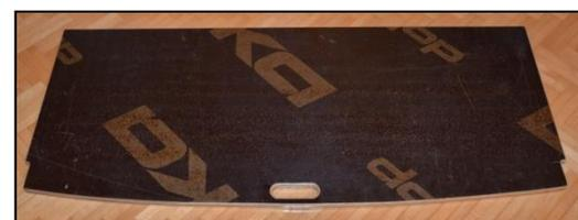
Die Platte ist der Krümmung der Heckklappe angepasst.
