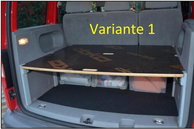
Zwei Dokaplaten (18 mm schichtverleimt, ca. 113x45cm) liegen links und rechts auf einen Hartholzträger (Querschnitt 15x50 mm) auf, der von jeweils 3 Stehern getragen wird. Insgesamt haben 6 Euro-Boxen darunter Platz.
