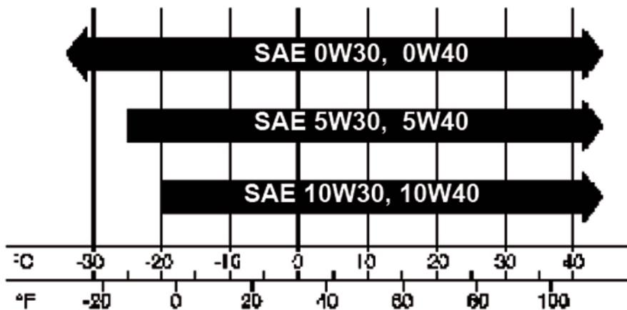
Die in der Tabelle aufgeführten Temperaturen dürfen beim X 25 DT- / Y 25 DT-Motor kurzfristig über- oder unterschritten werden.
