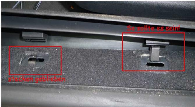
Es kann passieren, dass die Klips stecken bleiben (links) und sich aus der Verkleidung lösen. Diese dann einfach mit einer Zange aus der Karosserie lösen und wieder in die Verkleidung stecken.
