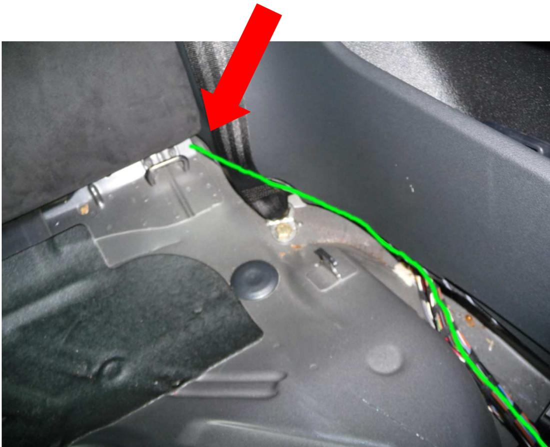
Dann mit dem bereits vorhanden Kabelstrang zusammenführen und entlang der Fußleisten verlegen. Dafür muss man den Teppich an manchen Stellen etwas anheben, damit man dahinter kommt. Ab und zu mal einen Kabelbinder verwenden, damit das Kabel da nicht irgendwo rumfliegt.
