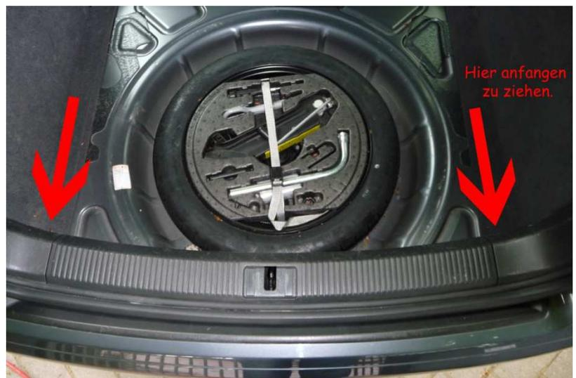
**!!Achtung!!** Bei der linken Seitenverkleidungen (die mit der Lampe) aufpassen und die Verkleidung nicht zu weit abziehen, da das Kabel der Lampe reißen könnte! Erst mal nur einen Spalt öffnen, der so groß ist, dass man an die Lampe kommt. Hier jetzt am besten die schwarze Plastikkappe abnehmen und dann die Lampe rausdrücken und schräg durch das Loch führen. So muss man nicht den Stecker abmachen, der meistens sehr fest steckt.
