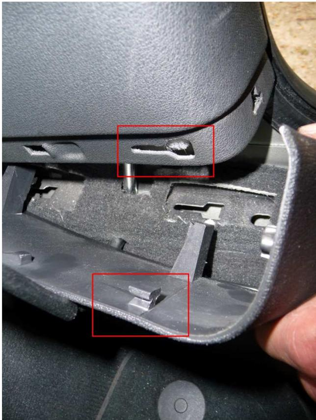
Die Verkleidung geht dann weiter im Fußraum unter der B-Säule. Diese ist nicht mit Klips befestigt sondern mit Stiften. Um diese Stifte zu lösen einfach die Verkleidung nach vorne, zum Fahrersitz hin, ziehen.
