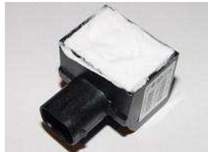
Mit Silikon die Platine wieder einkleben, die drei Pins anlöten und danach Luftdicht verfüllen.
