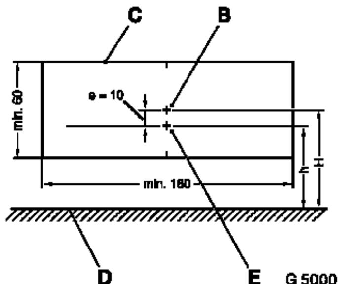
Die Scheinwerfereinstellung wird entsprechend den Vorschriften, wie in Bild D 6213 gezeigt, mit einem Einstellgerät durchgeführt. Bei Verwendung eines Scheinwerfereinstellgerätes müssen Fahrzeugstandflächen und die Aufstellfläche des Einstellgerätes eben und parallel zueinander sein.
