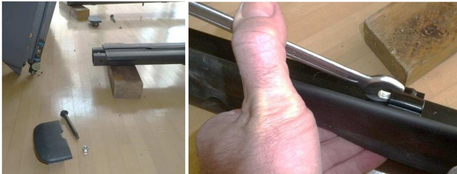
Bank ausbauen, Kunststoffkappen entfernen, Bank vorkippen, Gleitschienen nach hinten/oben durch betätigen des Bedienbügel-Sitzverstellung herausziehen. Die Kunststoffgummilippen L+R werden durch Metallklammern gehalten. Mit einem Maulschlüssel anheben und die Gummilippen entnehmen, easy!
