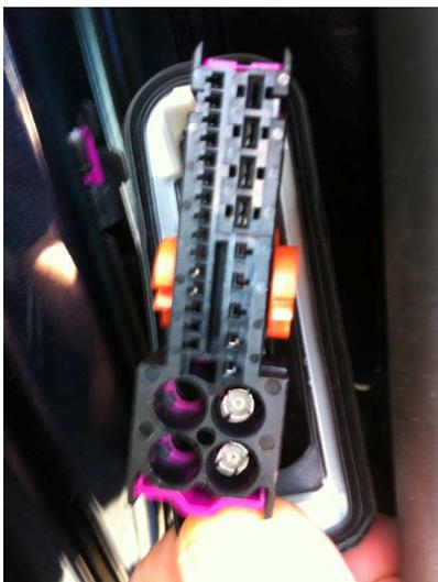
**Steckplatz entriegeln, zusätzliche Antennenleitung (W)**
