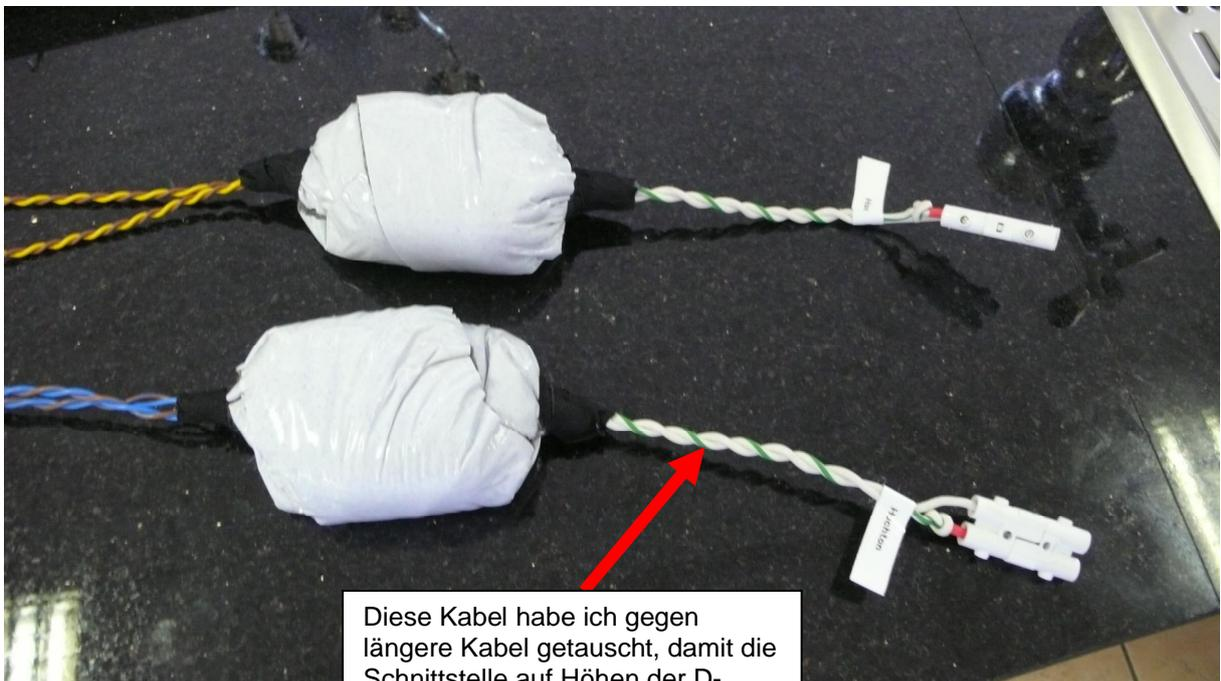
Diese Kabel habe ich gegen längere Kabel getauscht, damit die Schnittstelle auf Höhen der D-Säulenverkleidung ist. Hierdurch wird die Montage erleichtert.
