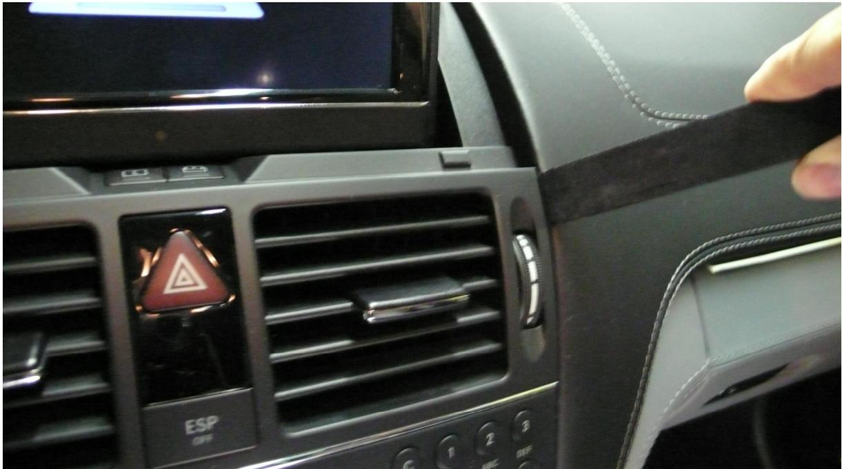
Mit einem Kunststoffkeil wird dabei zuerst die Lüftungsdüse oberhalb dem Command vorsichtig entfernt und dann die beiden Schrauben des Command lösen
