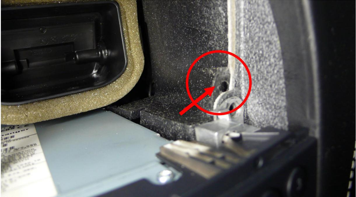
Nachdem die Schrauben los sind muss rechts und links der Schieberiegel vorsichtig nach oben geschoben werden.
