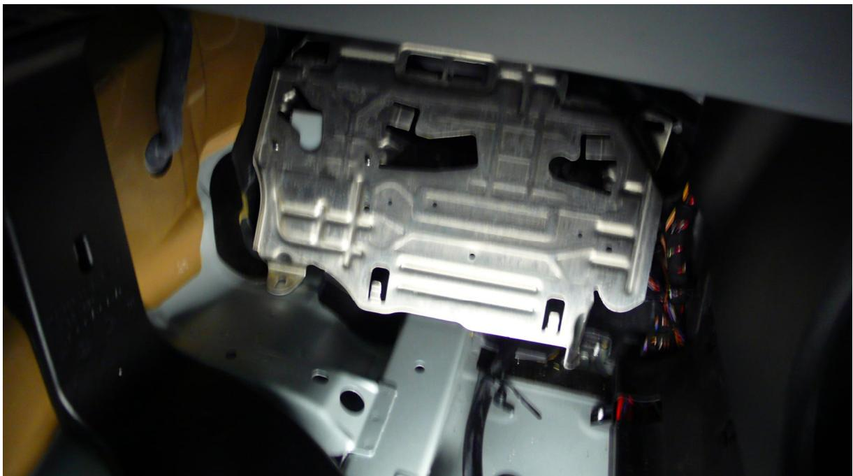
Ursprünglich wollte ich die Weichen unter der Fußablage im Beifahrerfußraum befestigen, was sich aber im Nachhinein als nicht machbar herausgestellt hat, da in diesem Bereich der Hauptkabelbaum herläuft und ich somit Lichtmaschinenpfeifen im Focal hatte und das auch bei ausgeschaltetem Command. Der Versuch die Weichen irgendwie abzuschirmen war leider auch gescheitert.
